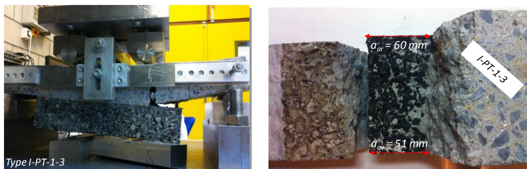
Figure 40. Rupture par décollement et faciès de rupture d'éprouvettes type BCMC testées hors eau à déplacement à vitesse de déplacement contrôlée de 0.7mm/s et à T°C ambiante (Hun, 2012)
