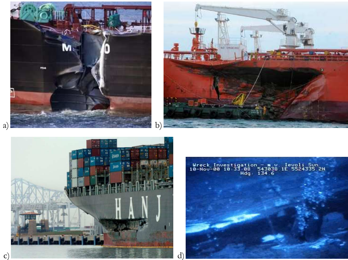
Figure IV.2 : Exemples de dommages : a) et b) collision entre deux navires a) le pétrolier Mindoro (Côtes hollandaises – 2000) ; b) le pétrolier MT Bunga Kelana 3 (entre la Malaisie et Singapour - 2010) ; c) porte-conteneur Hanjin après avoir heurté le pont de la baie de San Fransisco (2007) ; d) épave du Ievoli Sun (2000)
