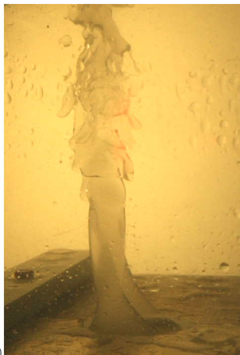
Figure III.12 : a) Sortie de DEHA et entrée d'eau à l'orifice (Urne2-DEHA-60/13-EMA_12), b) Schématisation de l'orifice vue de dessus
