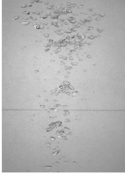
Figure II.11 : Amas de goutte dans la colonne d'eau (2- pentanone – CEC_10)
