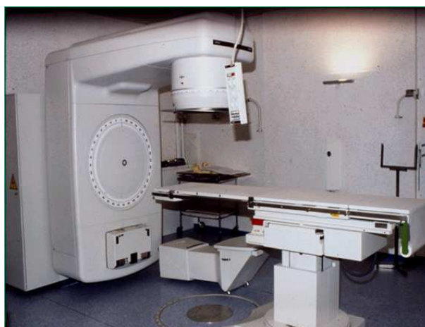
FIGURE 1.1 – Accélérateur linéaire de photon utilisé en radiothérapie
