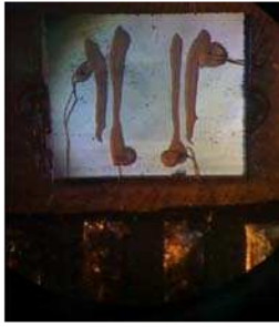
FIG. 37: Contacts en ligne réalisés à la laque argent.
