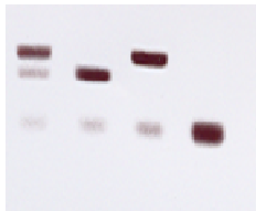
Figure 18. Génotypage de la souris déficiente en Nox2. Représentation du gel d'agarose révélant les produits de PCR. L'ADN des souris sauvages ( Nox2^{+/+} ) présente une bande à 240 paires de base, alors que celui des souris déficientes en Nox2 présente une bande unique à 195 paires de base et celui des souris femelles hétérozygotes présentera les 2 bandes.
