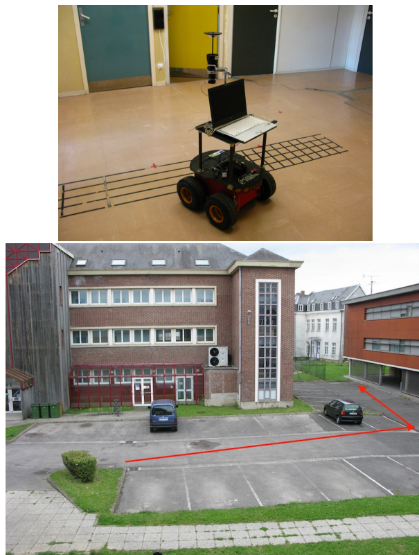
FIGURE 4.27 – Le robot mobile Pioneer équipé d'une caméra catadioptrique et son parcours dans le parking
