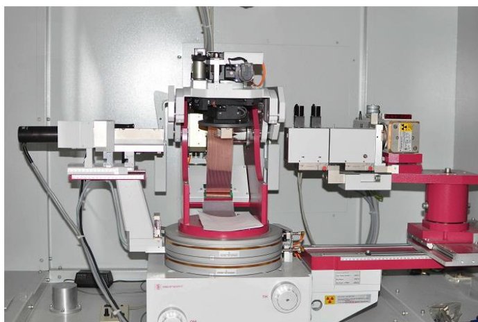
Figure III-7 – Photo du Diffractomètre de Rayons X (DRX), Seifert XRD 3003, installé au département SGM de l'IUT de Saint Brieuc
