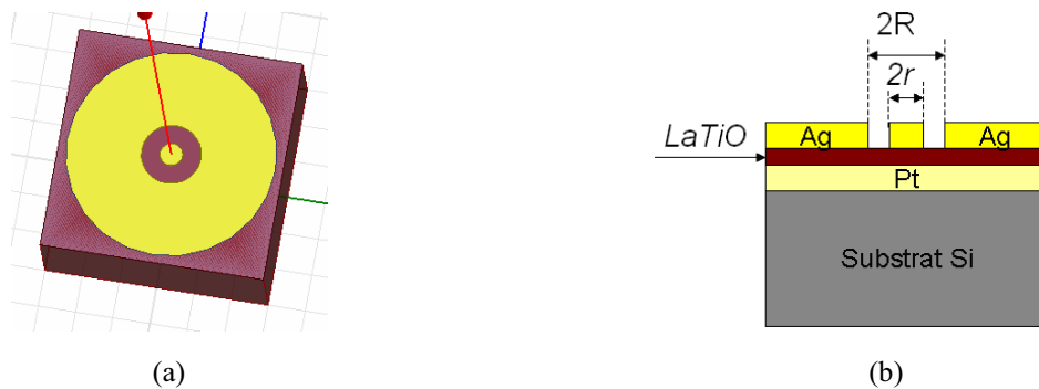
Figure V-16 – Structure de la capacité MIM a) Modèle de simulation b) vue en coupe
