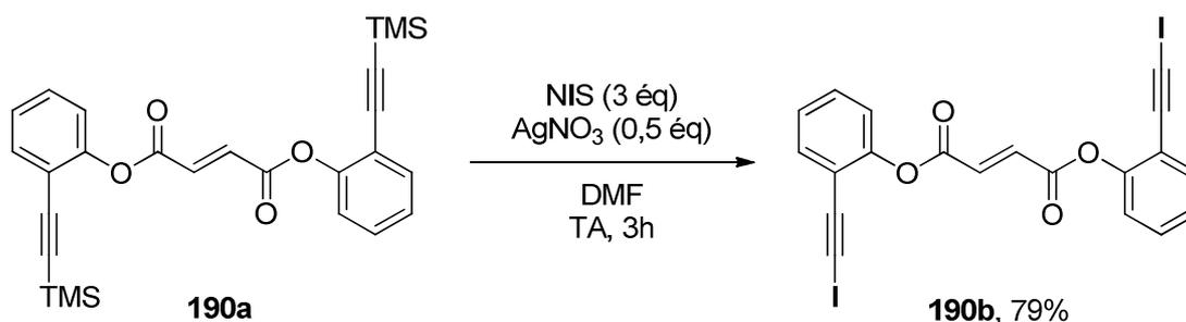
Schéma 3-33. Bis-*ipso*-iododésilylation de **190a**.
