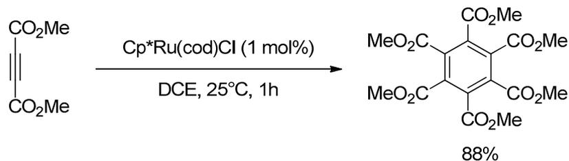
**Schéma 3-7.** Cyclotrimérisation du DMAD par un catalyseur au ruthénium, par Yamamoto.<sup>148a</sup>
