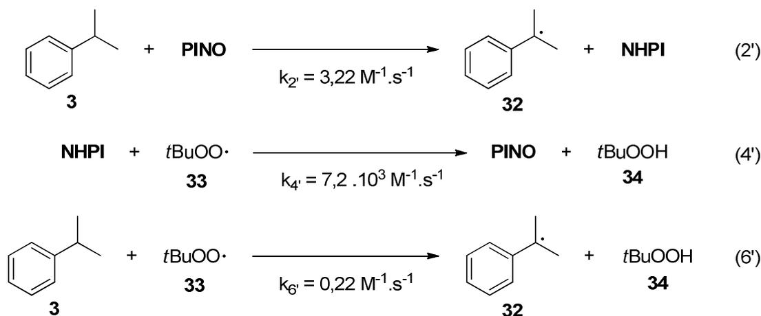
Schéma 1-14. Cinétiques des abstractions d'hydrogène dans l'oxydation du cumène.
