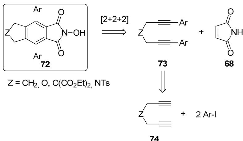
Schéma 1-33. Rétrosynthèse des composés polyaromatiques *via* cyclotrimérisation [2+2+2].
