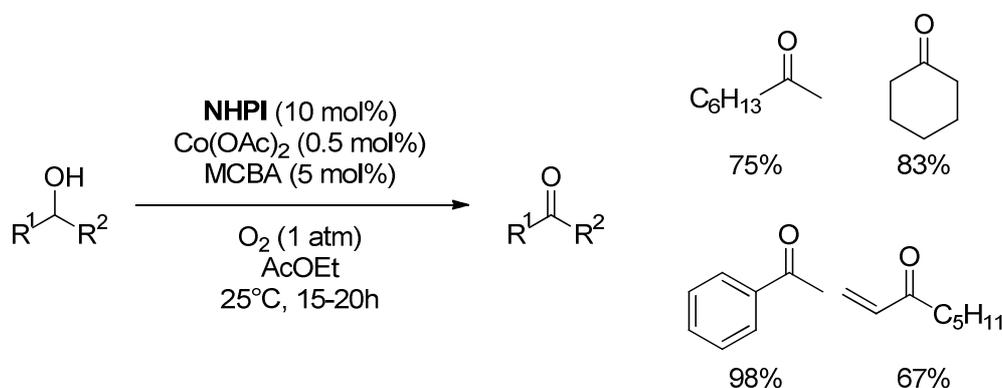
Schéma 1-24. Oxydation aérobie d'alcools secondaires par Ishii.
