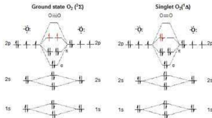
Figure 1-1. Diagramme orbitalaire des états de l'oxygène moléculaire.
