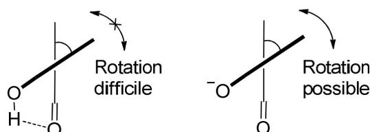
**Figure 4-4.** Importance de la liaison hydrogène dans la stabilité atropoisomérique des diphenolphtalimides. (vue de dessus, les plans des phényles sont représentés par des traits)
