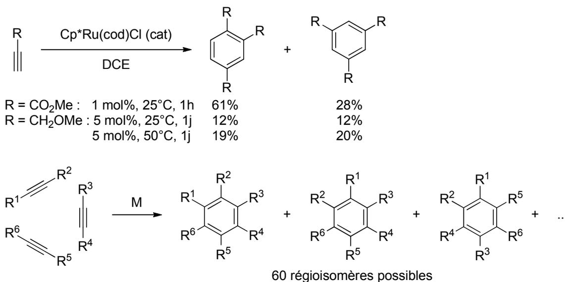
**Schéma 3-8.** En haut : exemple de cyclotrimérisation d'un alcyne vrai par un catalyseur de ruthénium, par Yamamoto.<sup>148a</sup> En bas : cyclotrimérisation générale de trois alcynes dissymétriques.
