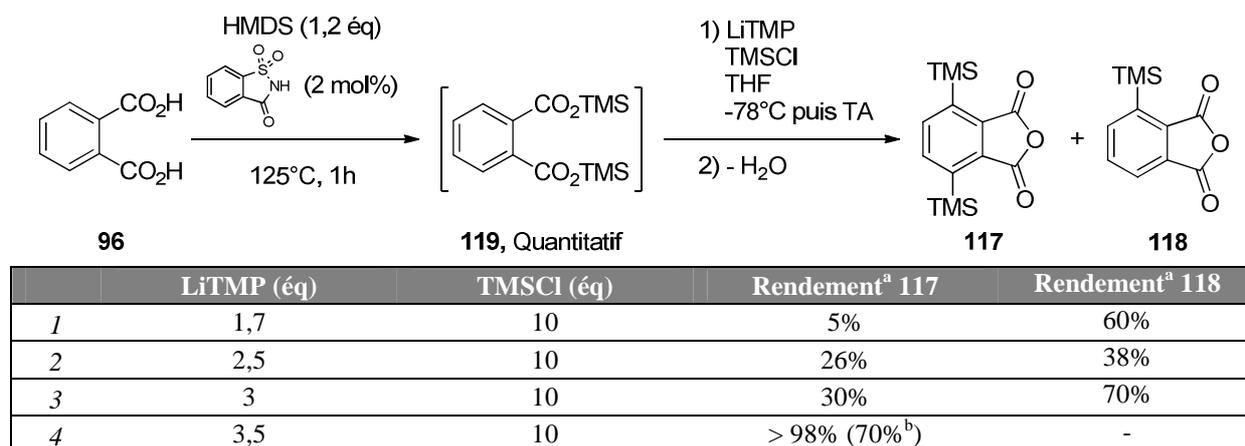
**Tableau 2-2.** Lithiation / silylation du phtalate de disilyle. <sup>a</sup> Rendement RMN brut. <sup>b</sup> Rendement isolé.
