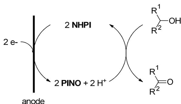
Schéma 1-17. Oxydation électrochimique d'alcools catalysée par NHPI.
