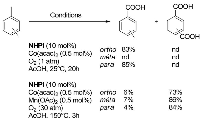
**Schéma 1-22.** Oxydations aérobie de xylènes en acides phtaliques catalysées par le NHPI.
