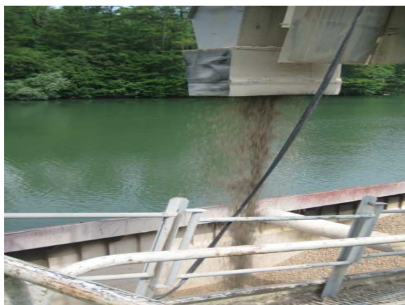
Chargement d'un bateau en granulats à partir de l'embranchement fluvial de la carrière, qui est constitué d'un ponton aménagé
