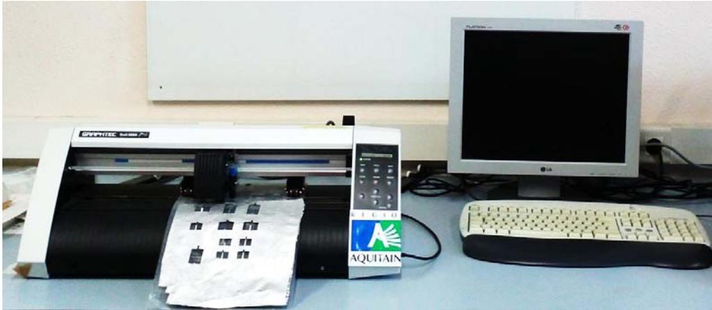
Figure 5 – Graphtec Craft Robo Pro : Machine de découpe cutter.
