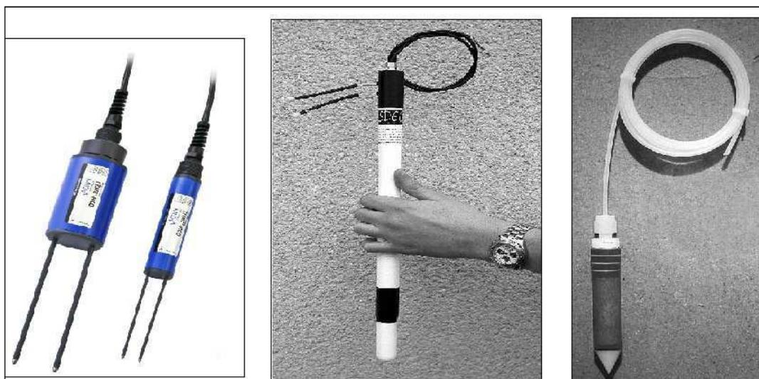
**Figure 18** Instrumentation du lysimètre, de gauche à droite: humidimètres, tensiomètre, cellule de prélèvement d'eau.
