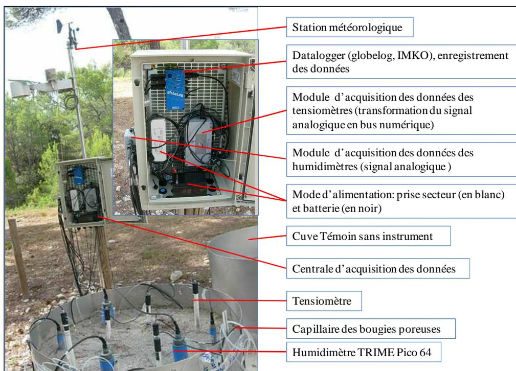
**Figure 19** Vue d'ensemble des instruments équipant la cuve et de la centrale d'acquisition des données.
