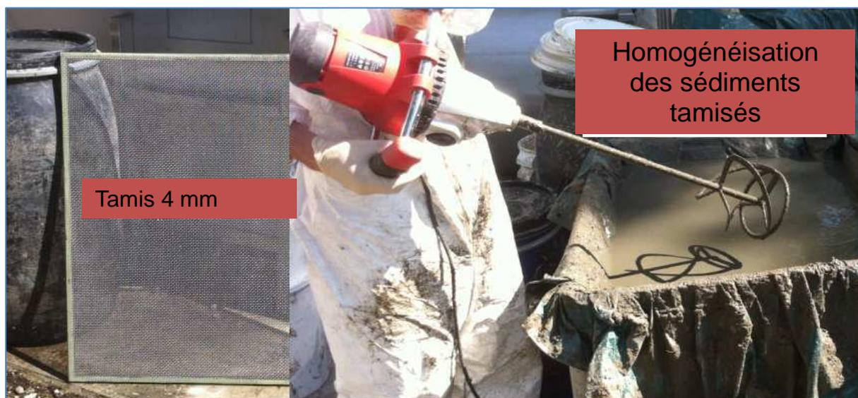
**Figure 11** Outils nécessaires au tamisage et à l'homogénéisation des sédiments prélevés
