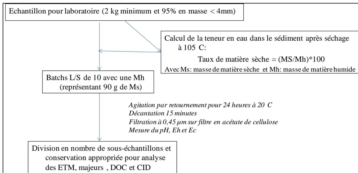
**Figure 16** Schéma du mode opératoire de la norme NF EN 12457
