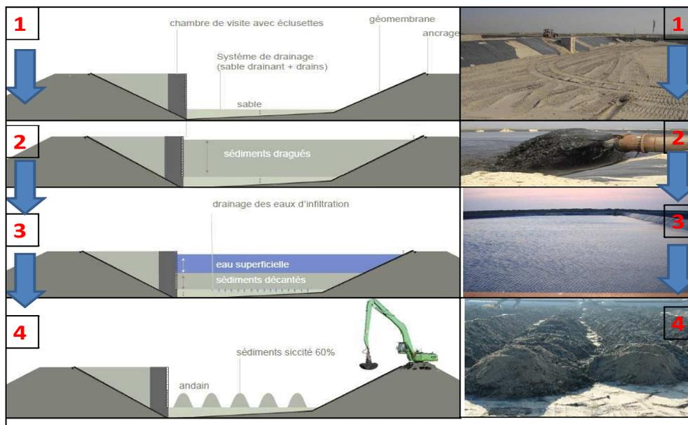
**Figure 1** Schémas et photographies d'une installation de lagunage actif pour la déshydratation de sédiments non immergeables issus des dragages du Grand Port Maritime de Dunkerque (Source: ENVISAN)
