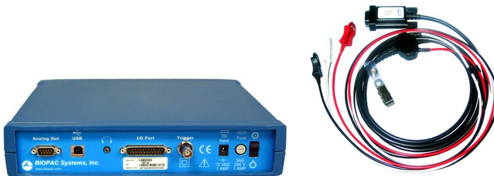
Figure 55 : Biopac MP36 : appareillage pour l'enregistrement de mesures cardiaques
