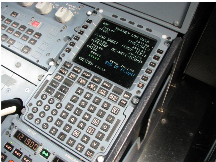
Figure 11 : Panneau de contrôle (MCDU) de l'ordinateur de bord (*Flight Management System*)<sup>18</sup>
