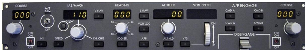
Figure 12 : Exemple de panneau de guidage (Flight Control Unit ou Mode Control Panel) <sup>19</sup>
