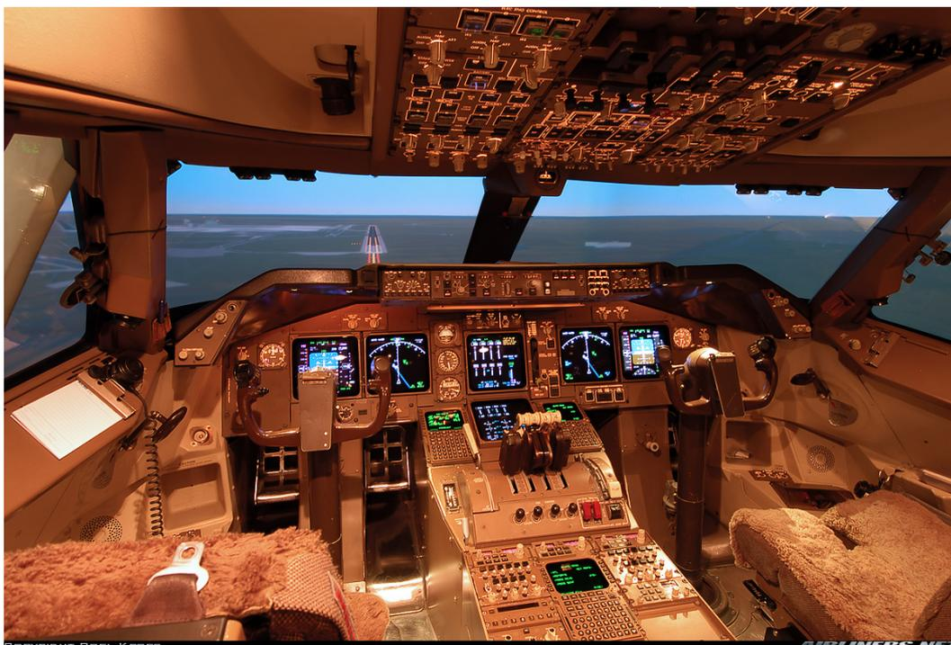
**Figure 7 : Cockpit de Boeing 747-400 : le manche est face au pilote, la poignée des gaz entre les deux pilotes<sup>9</sup>**
