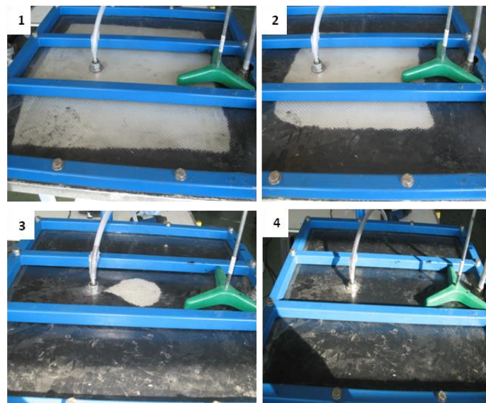
Figure 41 : Injection de la résine chargée en RTM-Eco après réduction de la taille de granulés
