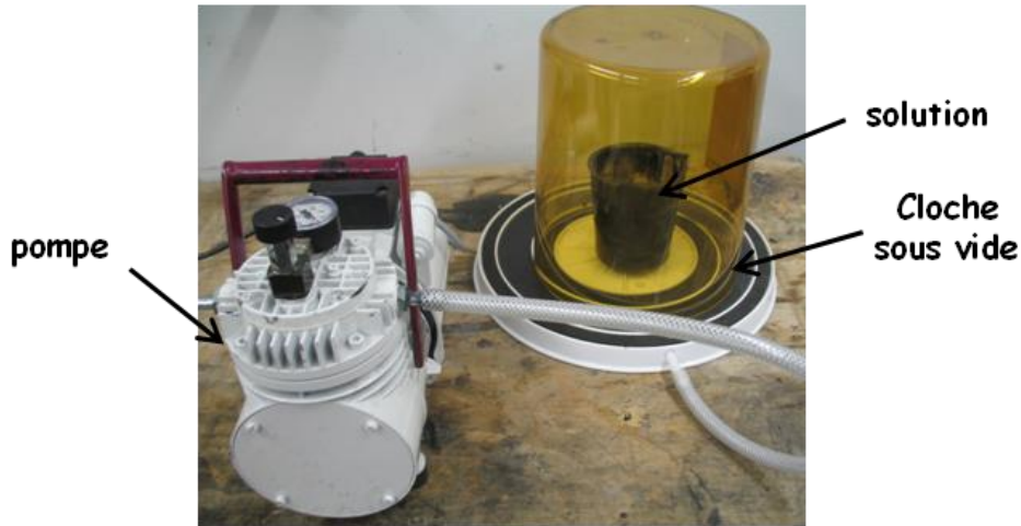
Figure 20 : dégazage sous vide
