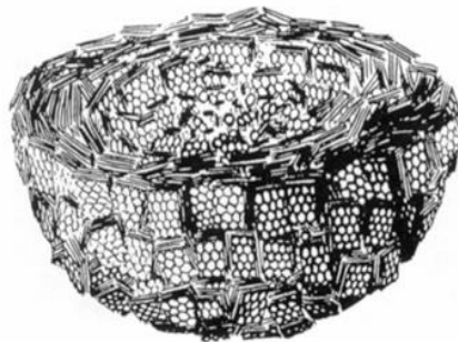
Figure 3 : Vue en coupe d'une particule de noir de carbone
