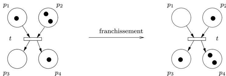
FIGURE 1.14 – Évolution d’un *réseau de Petri de base*.
