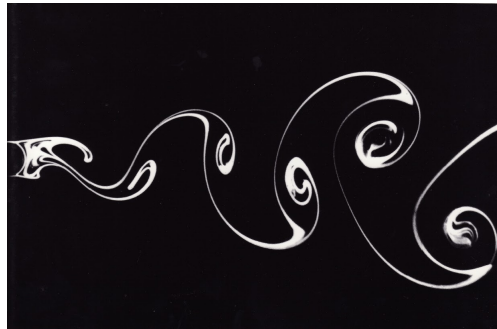
FIGURE 2 – Visualisation expérimentale de l'Allée de Bénard-von Kármán. D'après le livre de Van Dyke [139]
