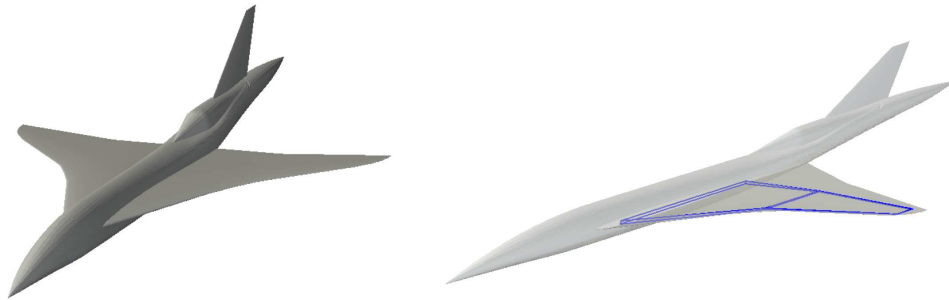
FIGURE 1.2 – Géométrie du modèle d'avion supersonique (gauche) et positionnement de la contrainte d'encombrement (droite).
