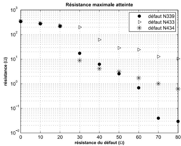
FIGURE III.25 – Résistances maximales atteintes par le SCFCL
