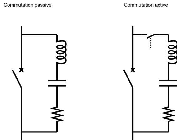
FIGURE III.2 – Méthodes pour forcer le passage du courant à zéro
