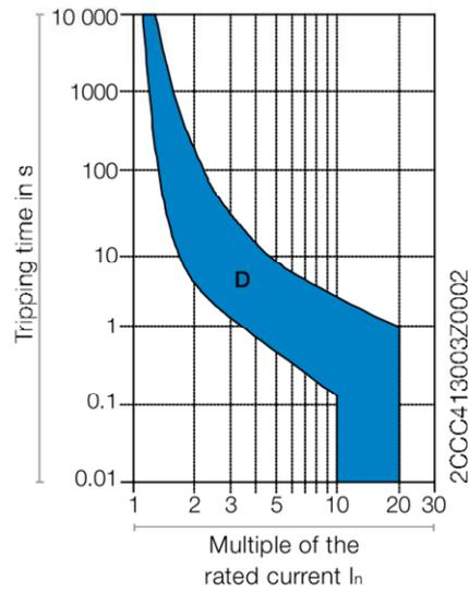
FIGURE IV.2 – Courbe D du type de disjoncteur installé
