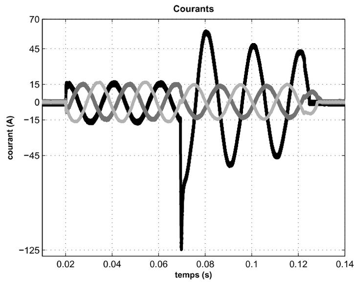
FIGURE IV.16 – Courants traversant le limiteur de courant pour un défaut monophasé de 250 V
