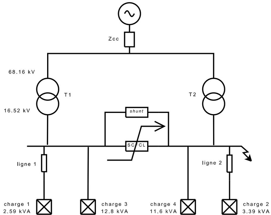
FIGURE II.16 – Réseau dans lequel le limiteur du projet Ecoflow sera installé dans un premier temps
