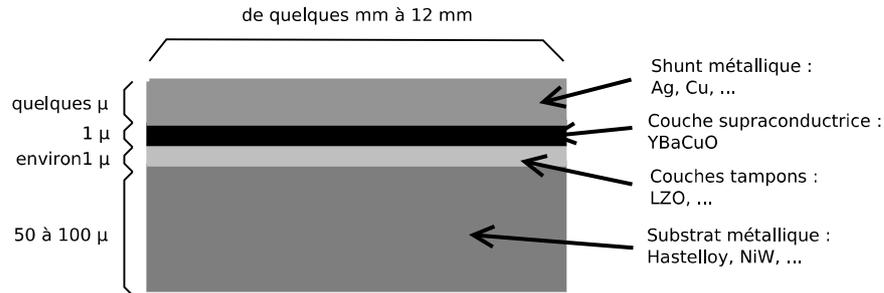
FIGURE I.2 – Structure type d'un conducteur déposé à base d'YBaCuO
