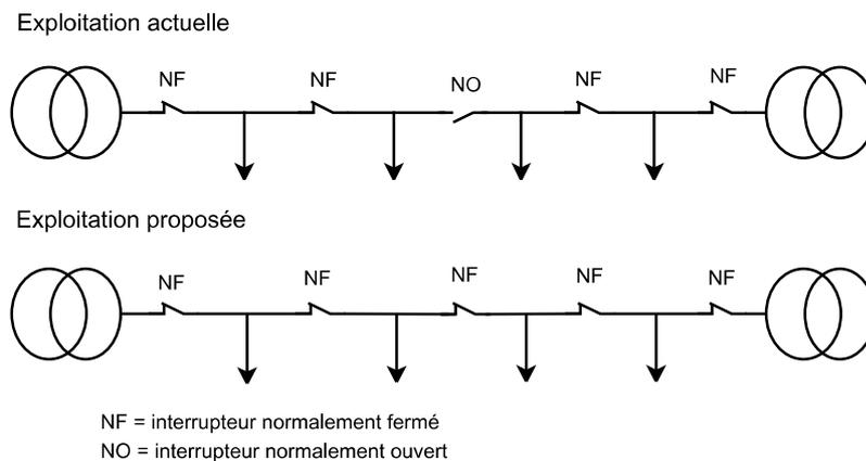
FIGURE III.11 – Exploitation actuelle (en France et dans la plupart des autres pays) du réseau de distribution et exploitation proposée dans cette partie
