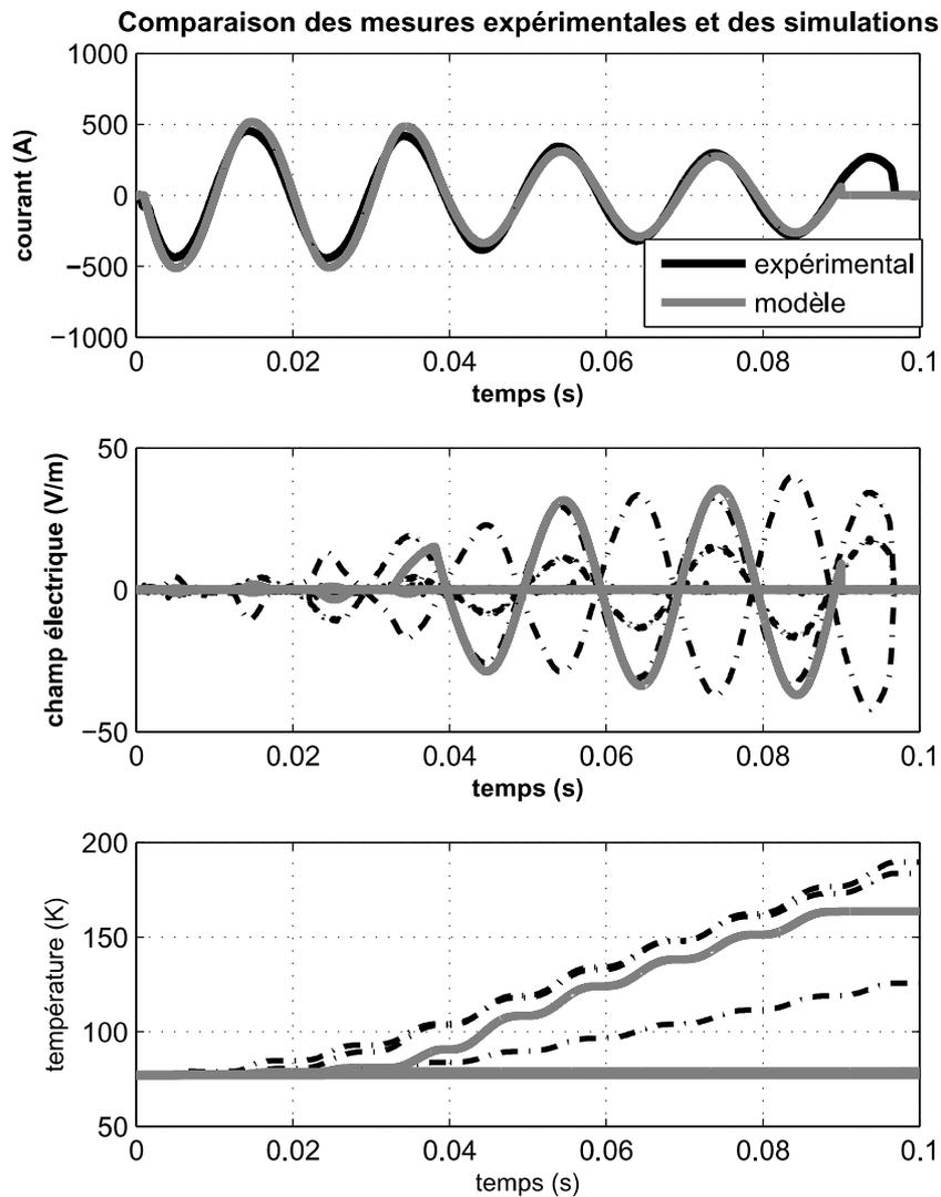
FIGURE I.17 – Comparatif des mesures expérimentales (en noir) et des résultats de simulation (en gris) avec cinq blocs de conducteurs en série pour un courant de défaut proche du courant critique
