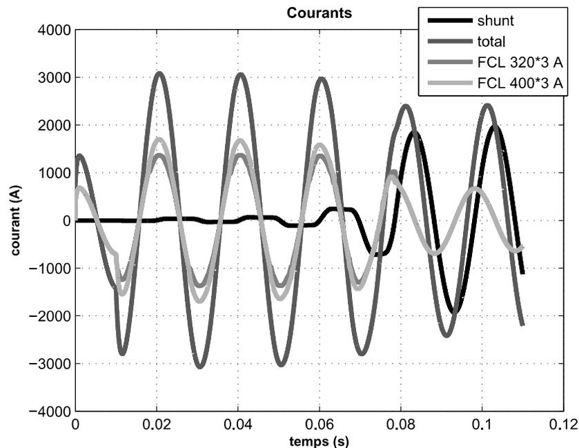
FIGURE II.11 – Courant passant dans le *shunt* en parallèle, courant passant chaque groupe de conducteurs constitué de 3 conducteurs en parallèle de 320 A et 400 A de courant critique et le courant total pour un défaut de 11  $\Omega$
