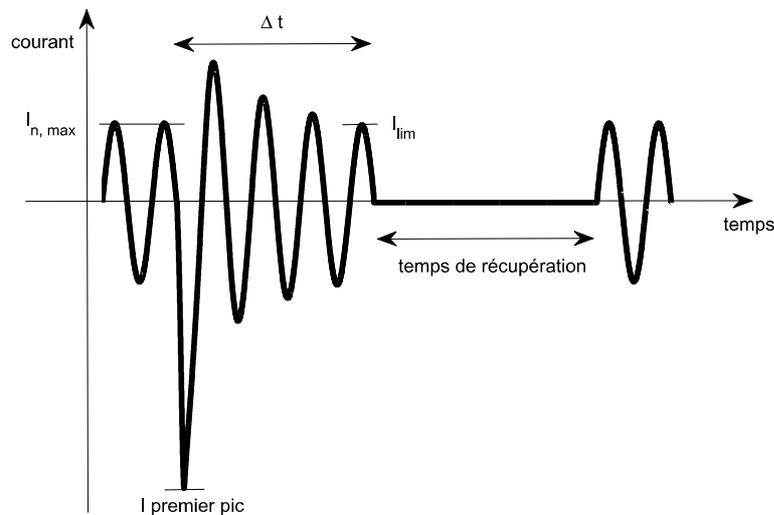
FIGURE II.7 – Forme d’onde du courant d’un limiteur de courant supraconducteur de type résistif. Les courants présentés sont  $I_{n,max}$ , la valeur maximum du courant nominal,  $I_{premier\ pic}$ , le courant maximum atteint lors du premier pic après le défaut et  $I_{lim}$ , le courant limité. Le temps de limitation du limiteur supraconducteur,  $\Delta t$ , et le temps de récupération de l’état supraconducteur sont aussi présentés sur cette figure.
