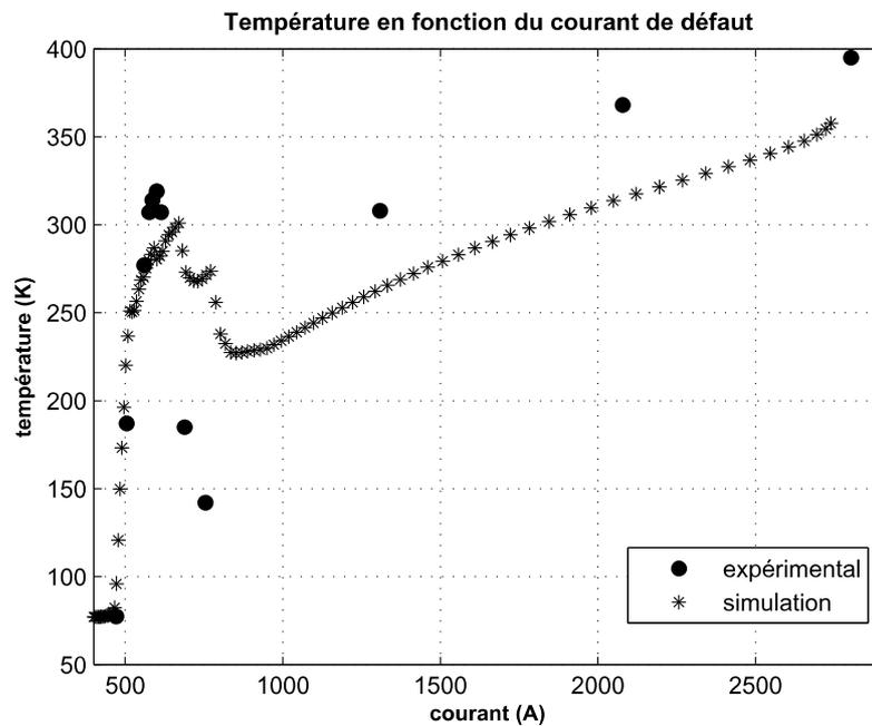
FIGURE II.14 – Température maximale du conducteur en fonction du courant *prospectif* (pour différentes impédances de défaut). Les résultats expérimentaux sont des mesures réalisées par le laboratoire du KIT (Allemagne).
