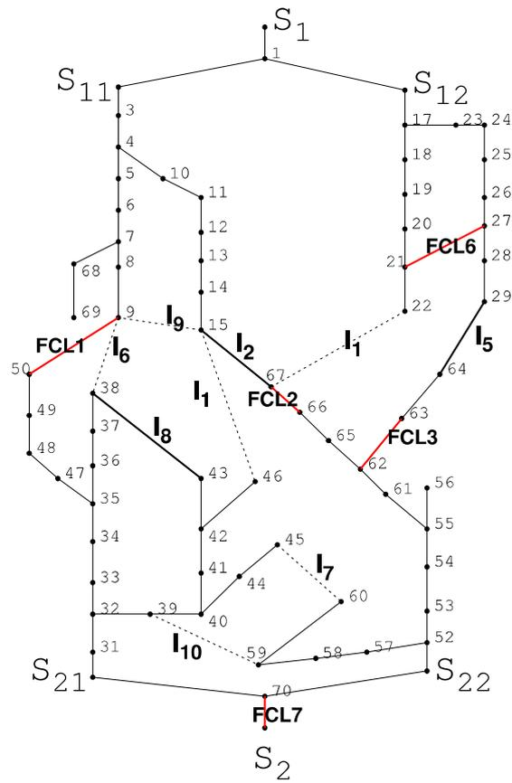
FIGURE III.44 – Réseau IEEE utilisé pour cet exemple avec en traits noirs épais les interrupteurs normalement ouverts qui sont fermés pour cet exemple, et en traits rouges épais l'emplacement des *déboucleurs rapides* dans le cas 2
