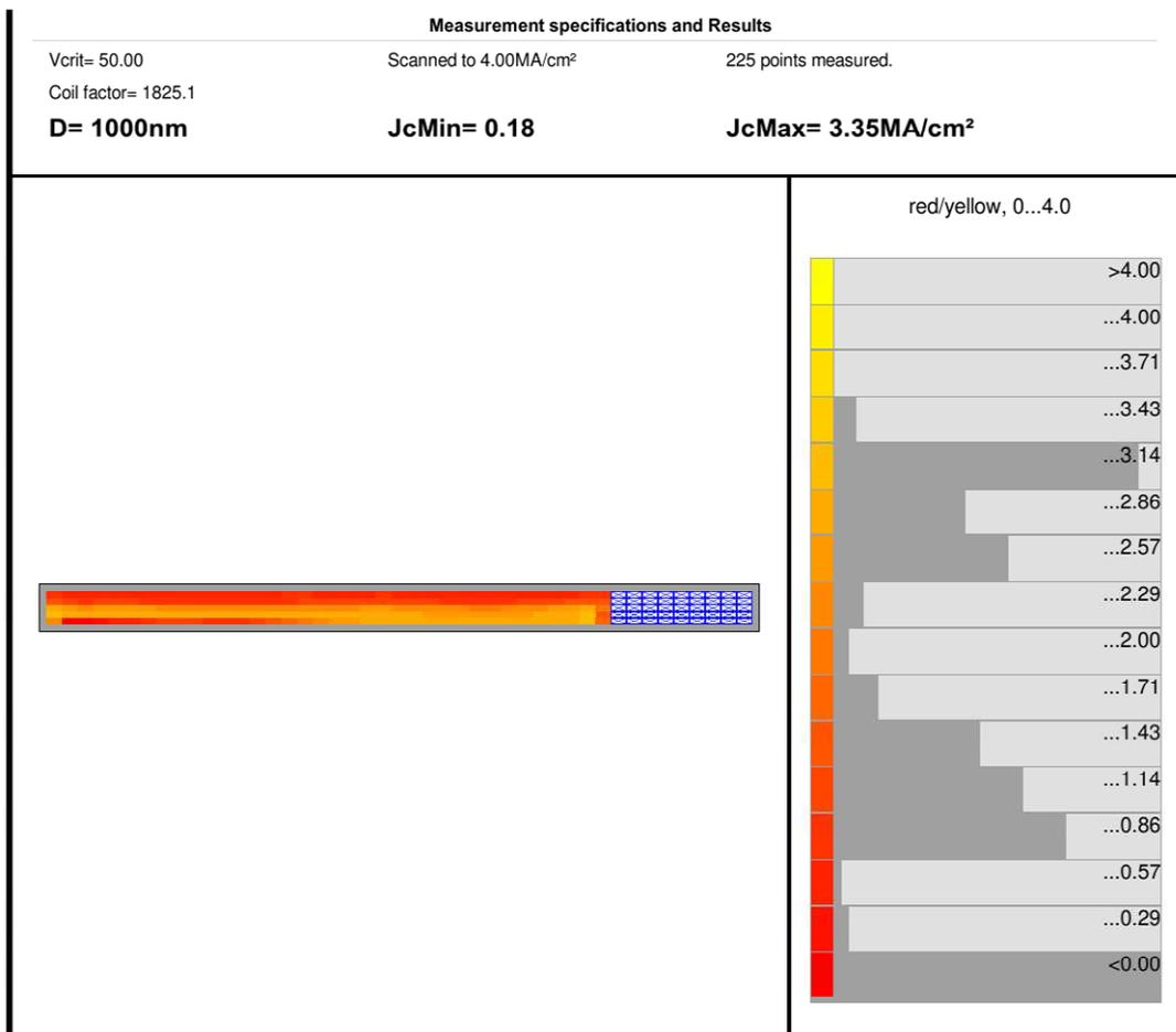
FIGURE I.4 – Mesure de courant critique d'un conducteur de environ 20 cm de long ; mesure réalisée par un *Cryoscan*<sup>®</sup>
