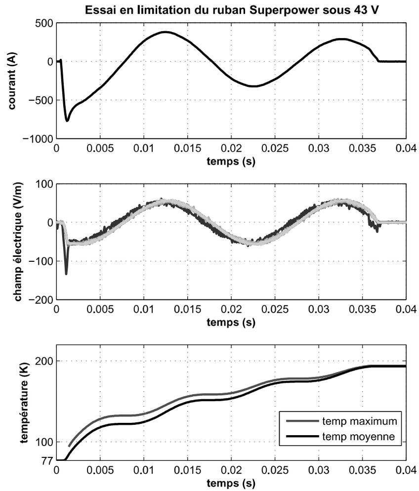
FIGURE I.13 – Essai en limitation de 1 m de conducteur de *Superpower*<sup>®</sup> à 43 V
