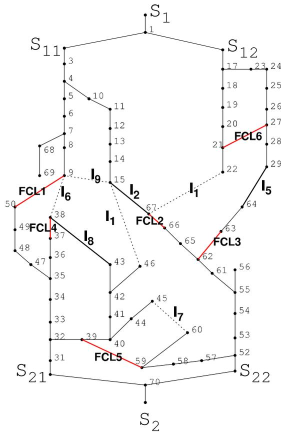
FIGURE III.43 – Réseau IEEE utilisé pour cet exemple avec en traits noirs épais les interrupteurs normalement ouverts qui sont fermés pour cet exemple, et en traits rouges épais l'emplacement des *déboucleurs rapides* dans le cas 1
