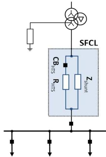
FIGURE II.6 – Emplacement du SCFCL dans le réseau de distribution à Kosice
