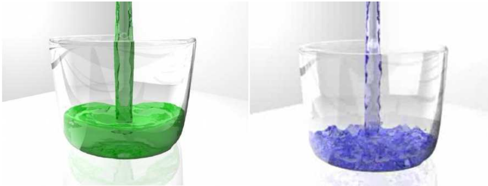
FIG. 3.1 – Simulation SPH d'un liquide visqueux (à gauche) et de l'eau (à droite)
