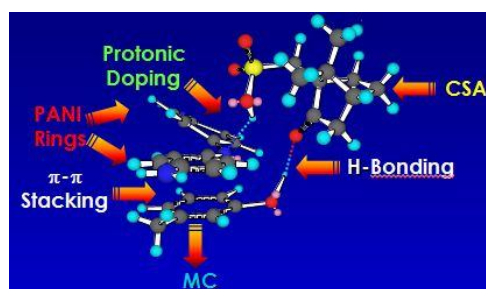
Fig. 6: Complexe supramoléculaire PANI/CSA/MC: Jeu d'interactions spécifiques et fit stérique 3D [33]
