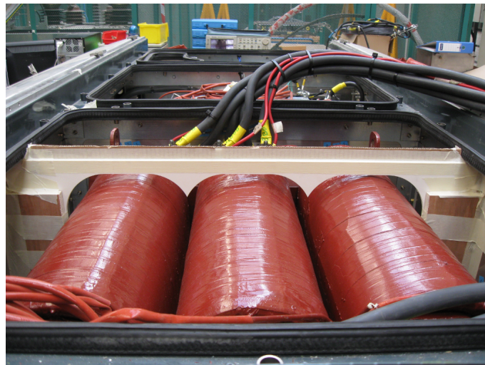
FIGURE 7.24: Transformateur à self intégrée dans le coffre auxiliaire
