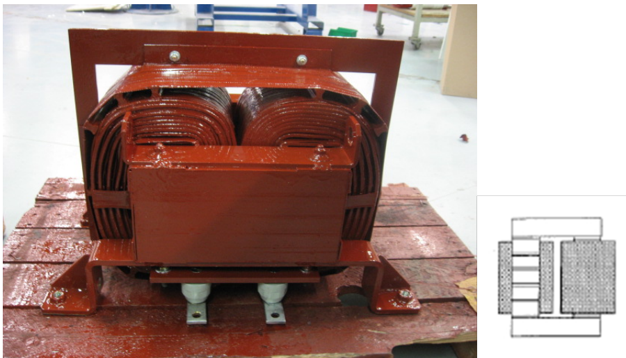
FIGURE 2.1: Exemple d'une self monophasée avec une vue en coupe
