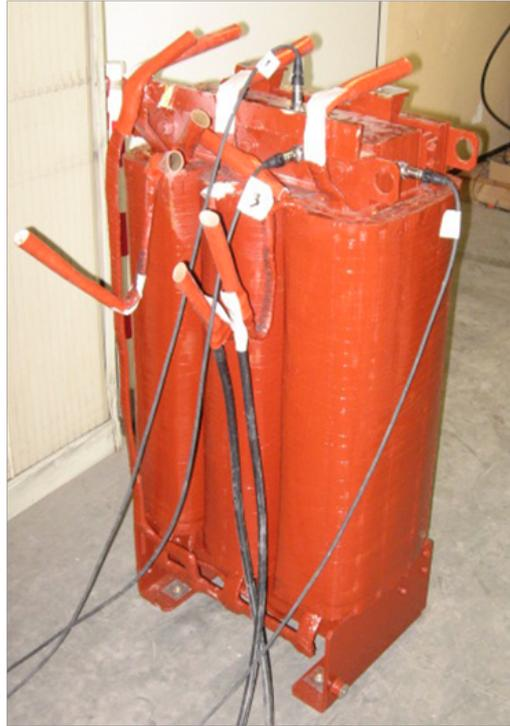
FIGURE 2.3: transformateur triphasé 200kVA 50Hz
