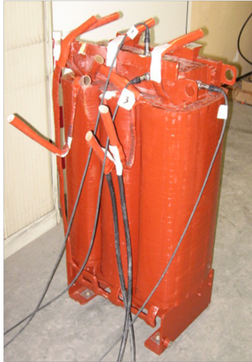
FIGURE 2.3: transformateur triphasé 200kVA 50Hz
