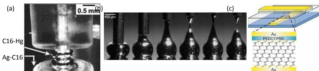
Figure 7 : Trois réalisations de jonctions moléculaires utilisant une électrode liquide : (a) contact d'une SAM de C16 alkylthiol greffée sur substrat d'argent par une goutte à mercure fonctionnalisée par une SAM de C16 alkylthiol selon [90]; (b) Images successives de la formation d'une pointe d'eutectique Galn après dépôt de la goutte sur un substrat sacrificiel selon [99]; (c) Contact de la SAM dans un micropore de 40 à 80 \mu\text{m} de diamètre par PEDOT/PSS selon [100].
