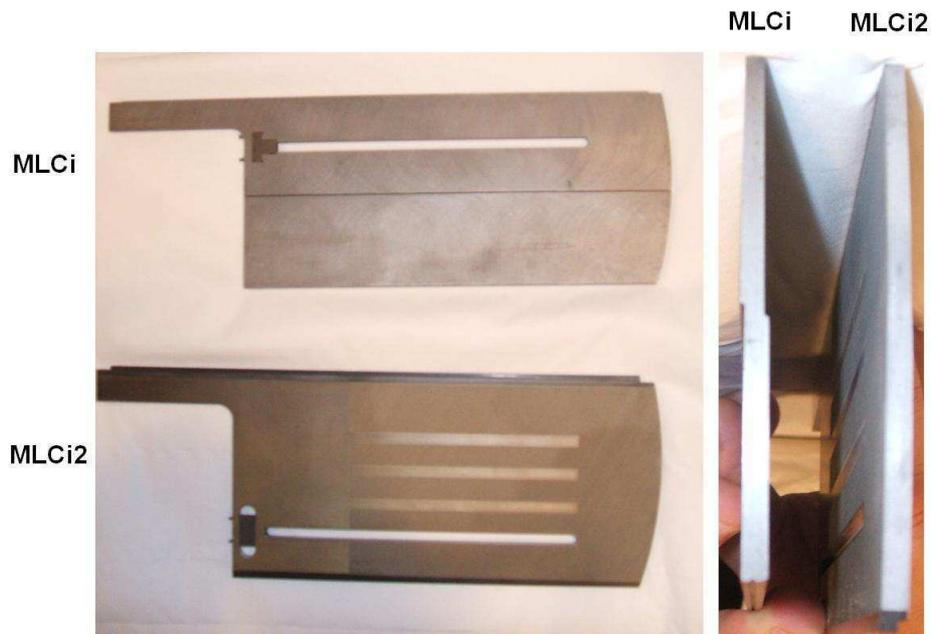
Figure 17 : Photographies de face et de profil de lames issues du MLCi, avec un côté de lame en tenon mortaise et du MLCi2 avec un côté de lame plat.
