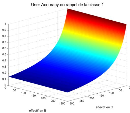
figure II.5 : Simulation de l'indice UA pour la classe 1
