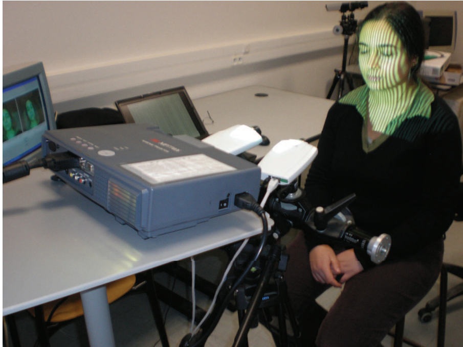
FIGURE 3.2 – Notre système de numérisation 3D.
