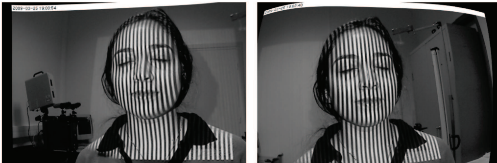
FIGURE 3.16 – Correction de la distorsion radiale et tangentielle.
