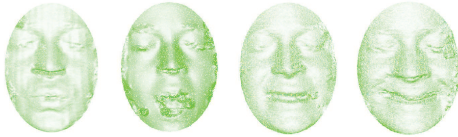
FIGURE 4.27 – Quelques erreurs de numérisation générées par notre système de numérisation 3D.
