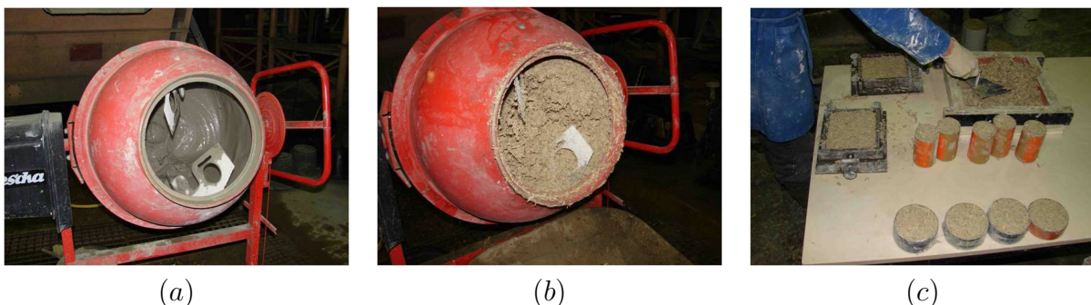
Figure II.16 – Fabrication des échantillons de béton de chanvre, préparation du liant (a), mélange homogène de béton de chanvre (b) et fabrication des échantillons (c)
