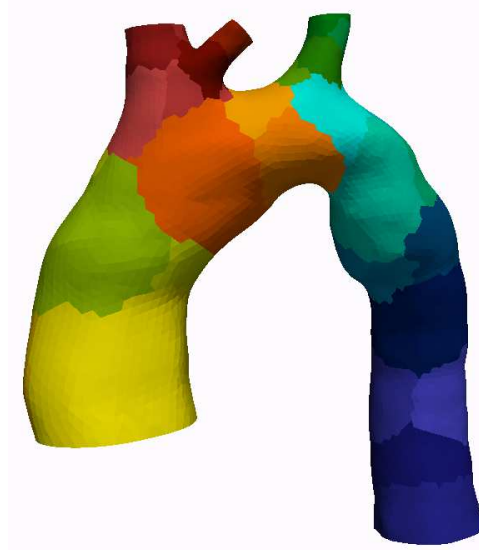
FIGURE 7.16 – Maillage M4 de l’aorte avec 32 partitions. Chaque couleur représente une partition.
