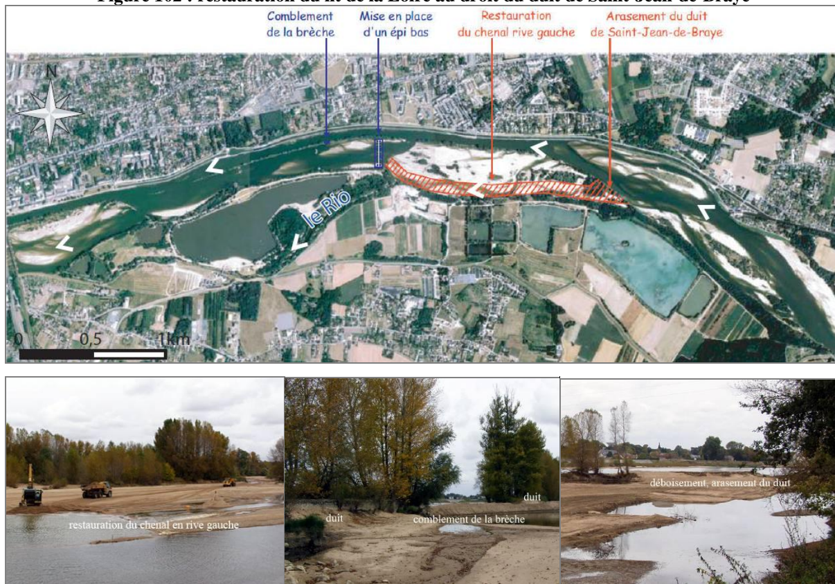
Figure 102 : restauration du lit de la Loire au droit du duit de Saint-Jean-de-Braye
