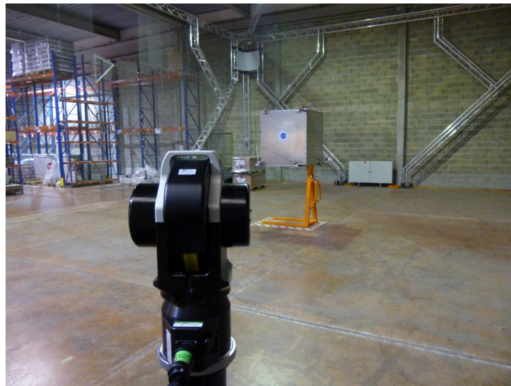
FIG. 4.1 – Tête du laser tracker
