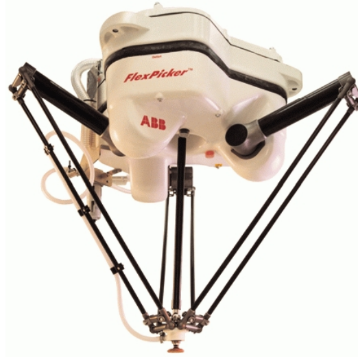
FIG. 1.4 – Un robot Delta industriel : le FlexPicker (ABB Flexible Automation)
