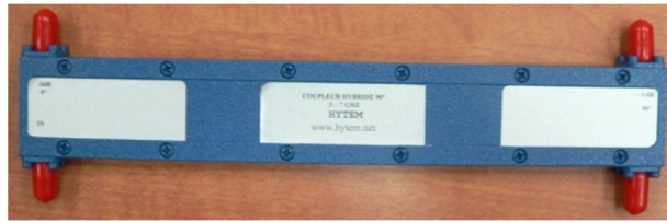
Figure 2.32. Coupleur hybride 90^\circ .
