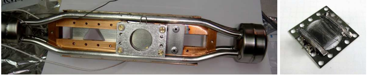
FIGURE 4.8 – À gauche : photographie du montage du convertisseur e^- \rightarrow e^+ . Le convertisseur est disposé derrière l'orifice circulaire au centre du porte cible. La plaque dans laquelle est creusée l'orifice est destinée à supporter un modérateur. Le support peut être translaté afin que le faisceau incident irradie soit le convertisseur central, soit un deuxième convertisseur (à droite), soit un dispositif d'étude du faisceau d'électrons (à gauche). À droite, photo d'un modérateur en multicouche de grilles de tungstène. Les grilles ont des dimensions de 18 \text{ mm} \times 18 \text{ mm} .
