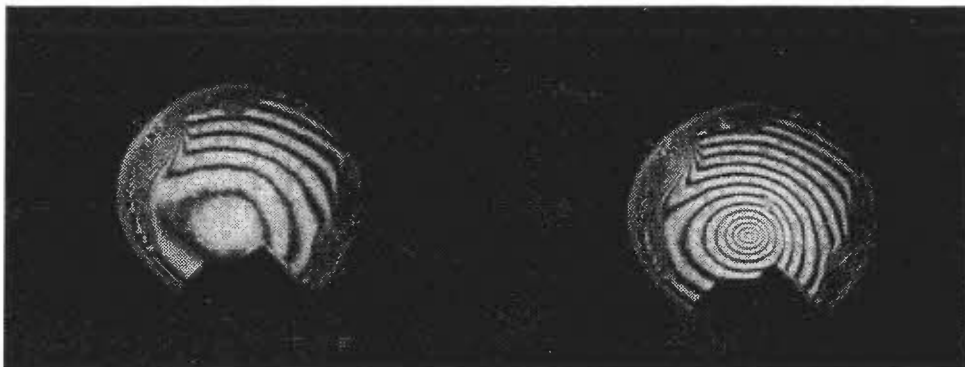
figure 5-29 : Franges d'interférences visualisées sur le matériau sans et avec pompage optique pour le QE7S.
