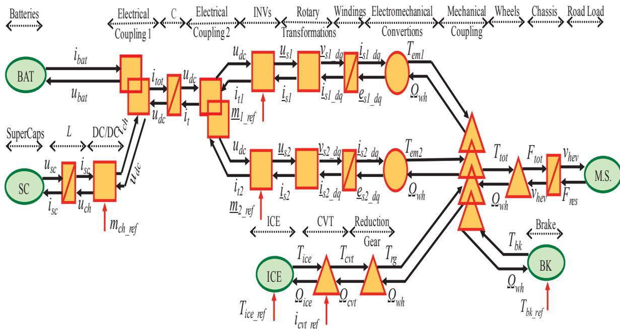
Figure 3.18 : Modèle REM du véhicule PHEBUS.
