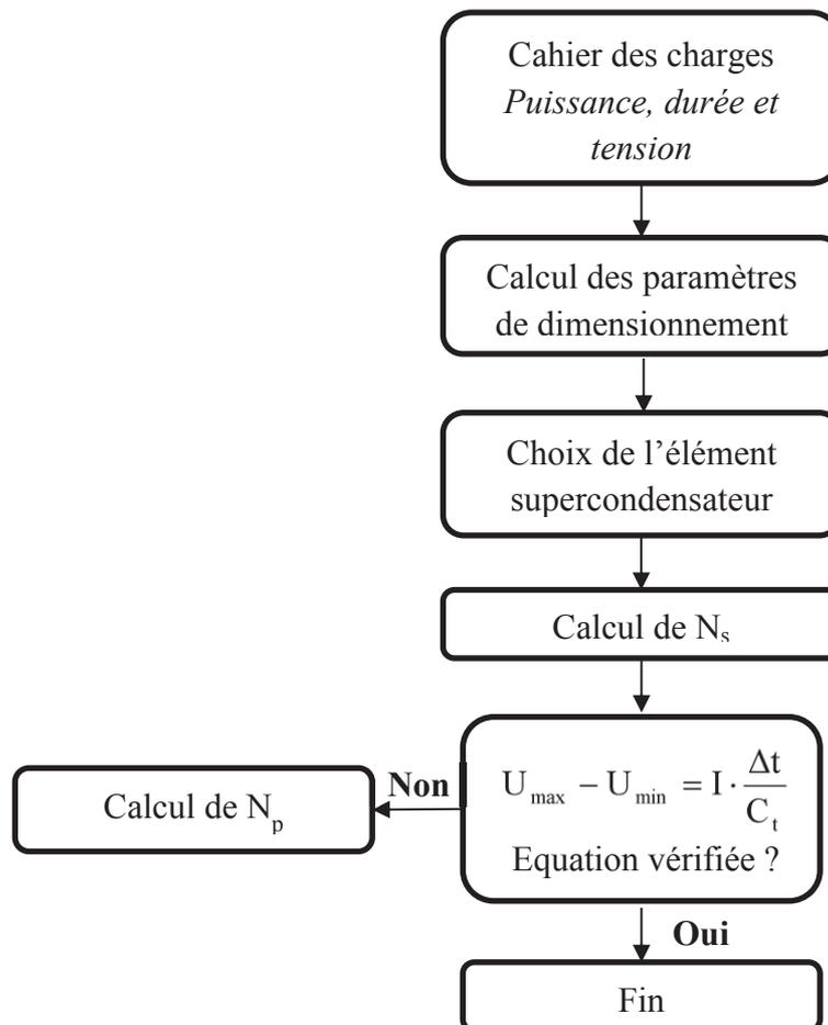
Figure 2.6 : Algorithme de calcul des supercondensateurs.
