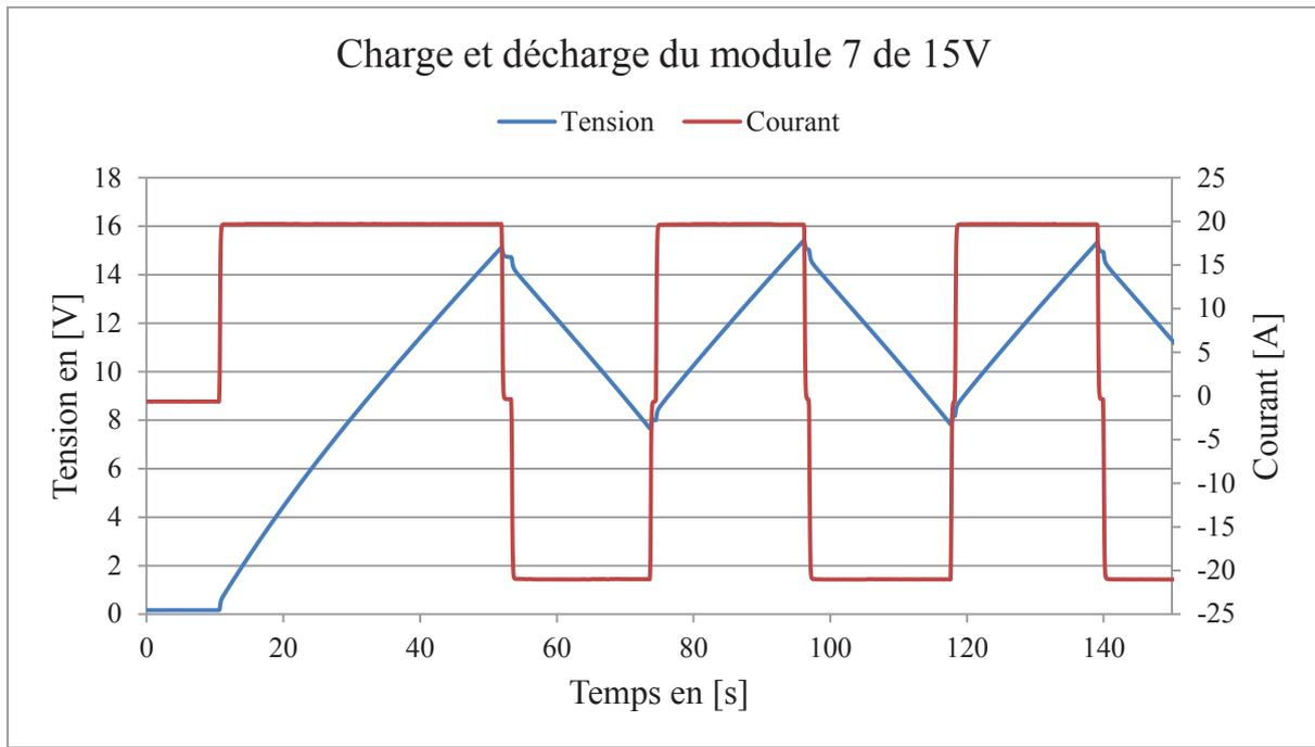
Figure 2.29a : Courant et tension de charge-décharge.
