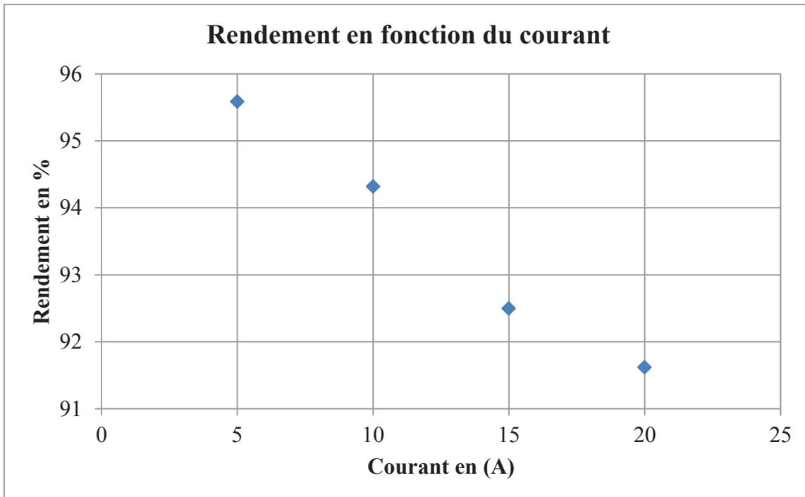
Figure 2.28 : Rendement énergétique.
