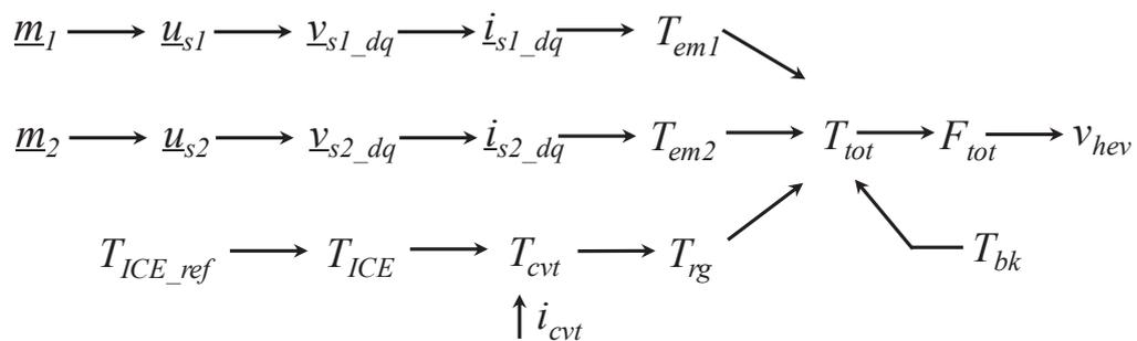
Figure 3.21 : Chaîne de réglage de la vitesse.
