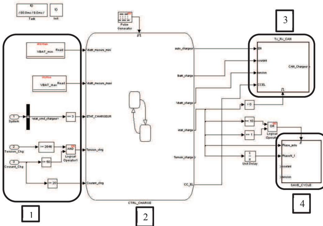
Figure 4.23 : Schéma Simulink du chargeur de batterie.
