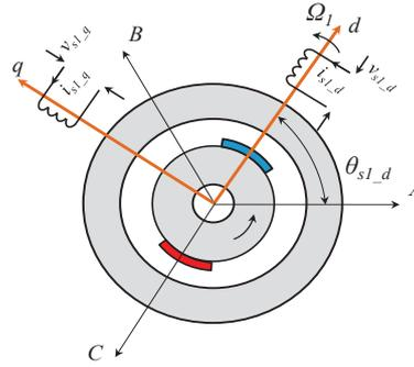
Figure 3.14 : Modèle physique d'une MSAP à deux pôles.
