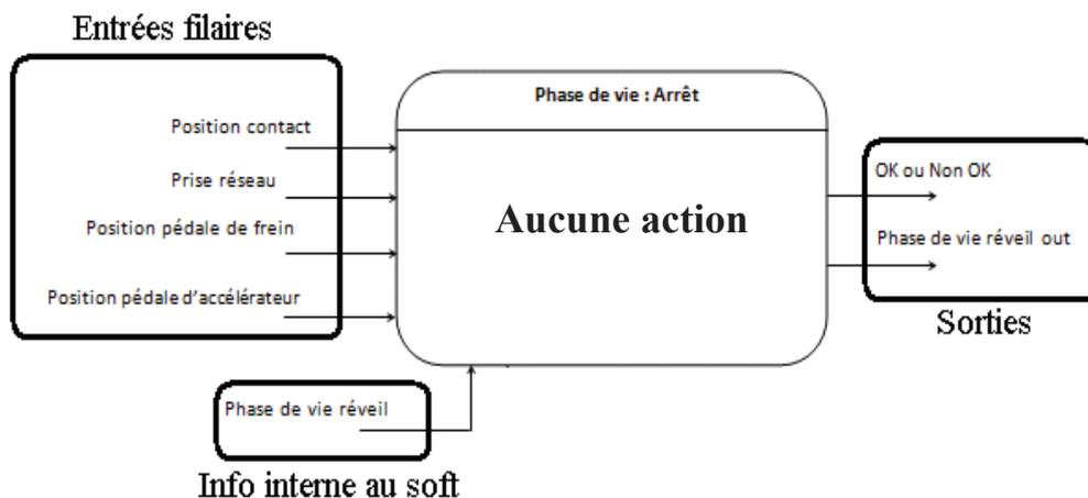
Figure 4.2 : Modèle phase de vie "Arrêt".
