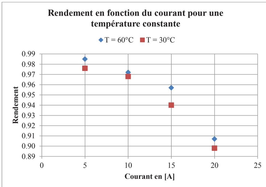
Figure 2.34 : Rendement en fonction du courant.
