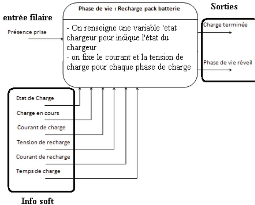
Figure 4.4 : Modèle phase de vie "Charge batterie".
