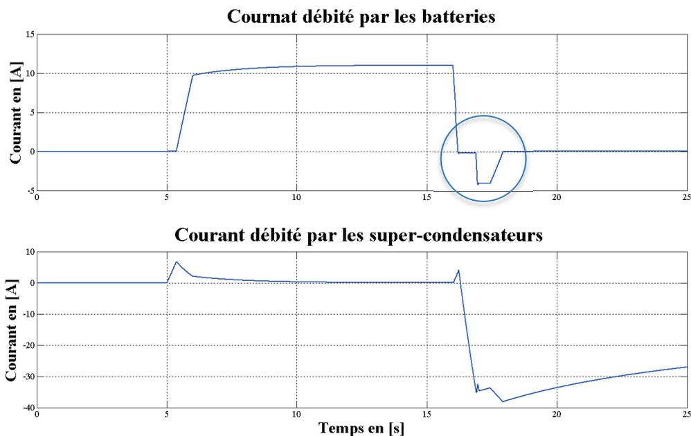
**Figure 3.31 :** Courants batterie et supercondensateurs.
