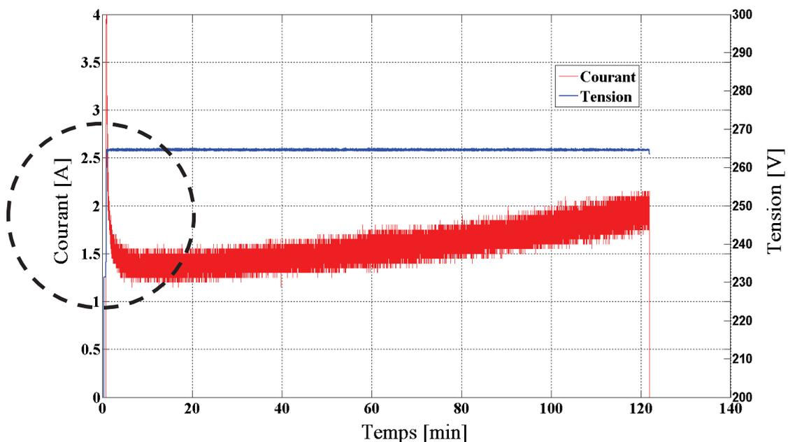
Figure 5.11 : Tension et courant des batteries durant la charge à tension constante.
