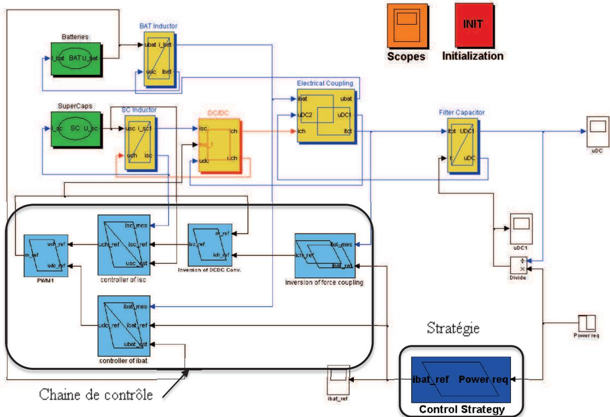
Figure 3.29 : Schéma de simulation du couplage des sources électriques.
