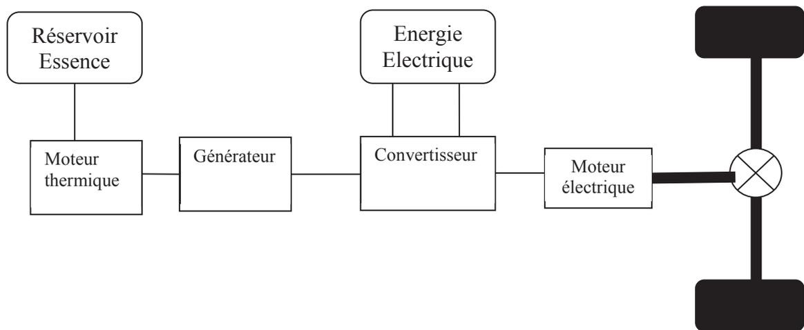
**Figure 1.5 :** Architecture série d'un véhicule hybride.
