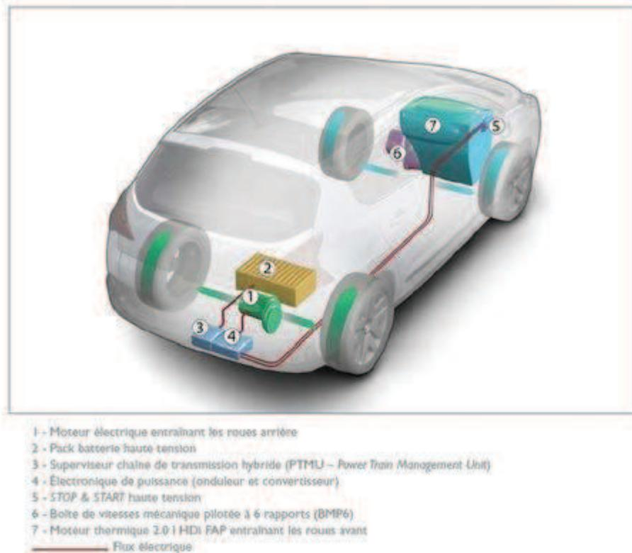
**Figure 1.10 :** Schéma fonctionnel de la Peugeot 3008 hybride.
