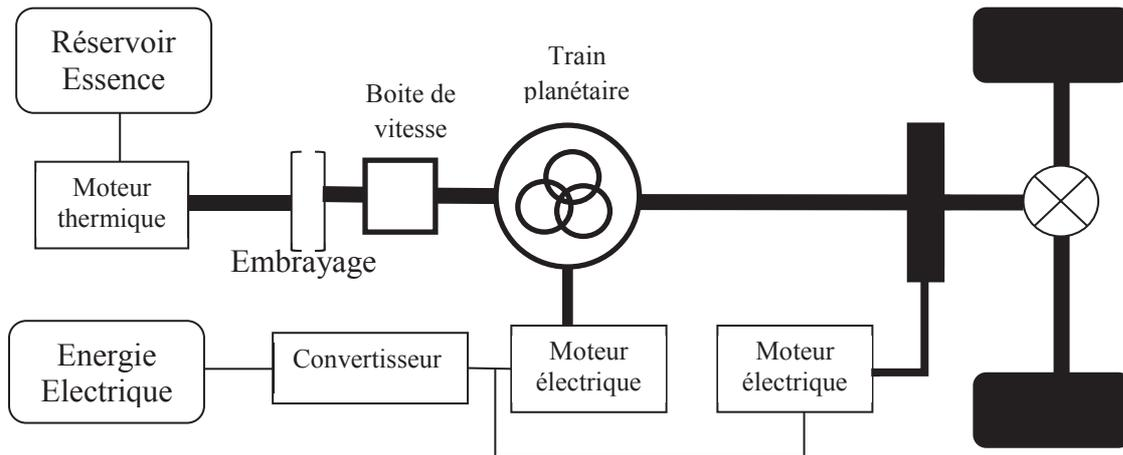
**Figure 1.7 :** Architecture série-parallèle d'un véhicule hybride.
