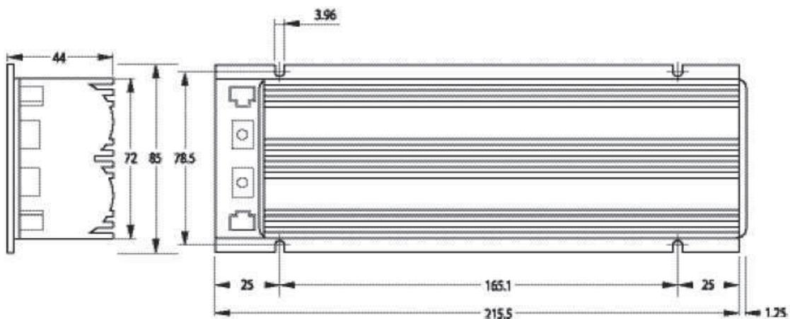
Figure 2.14 : Différentes cotes du module BMOD0058.
