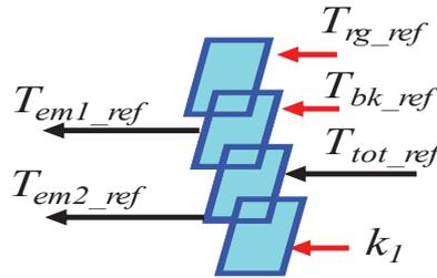
Figure 3.25 : Inversion des éléments de couplage mécanique.
