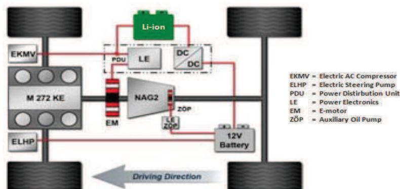
Figure 1.17 : Schéma d'implantation de la Mercedes S400 BlueHYBRID.
