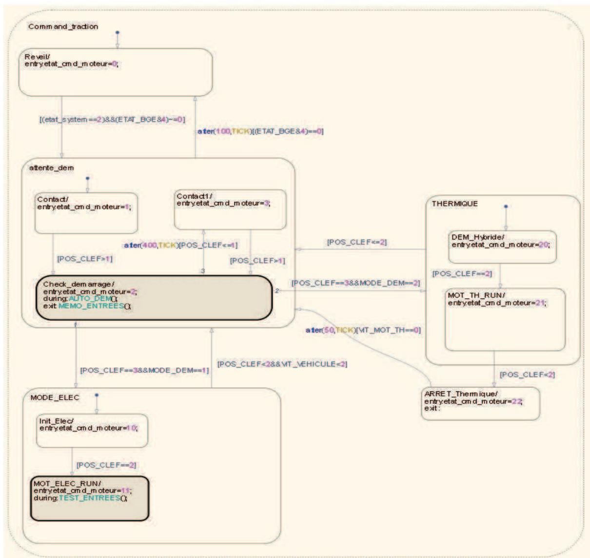
Figure 4.34 : Machine d'état de commande de la conduite.
