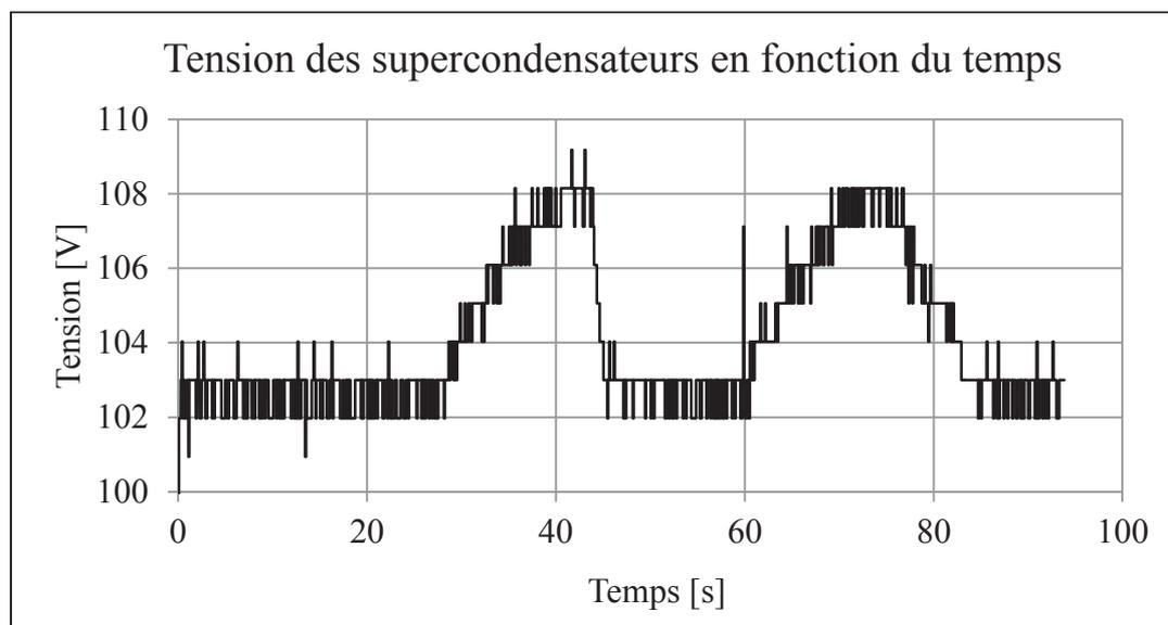
**Figure 5.23 :** *Energie dans les supercondensateurs.*
