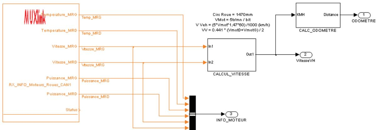
**Figure 4.15 :** Bloc Simulink des informations du moteur.
