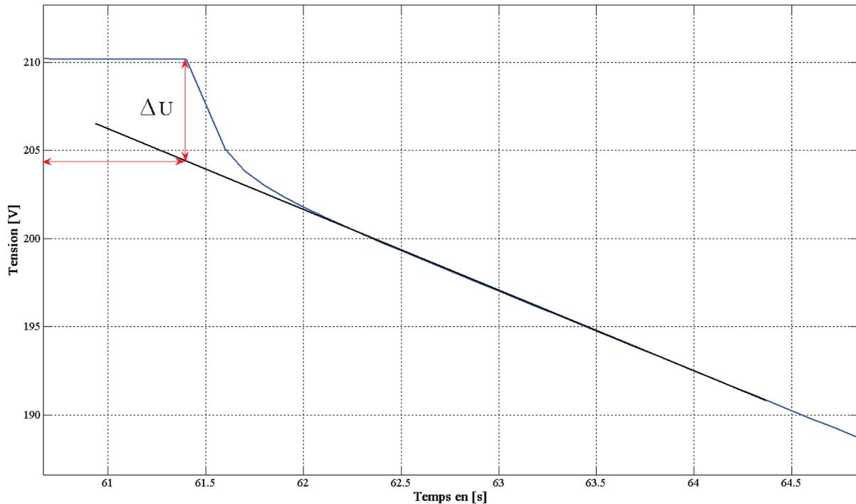
**Figure 2.26 :** Illustration de la chute de tension lors de la décharge pour  $I = 20A$ .
