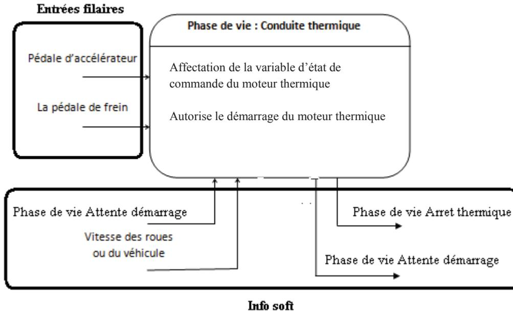
**Figure 4.7 :** *Modèle phase de vie "Conduite thermique".*
