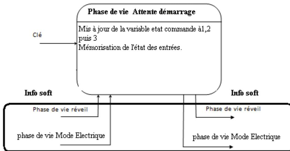
Figure 4.5 : Modèle phase de vie 'Attente démarrage'.
