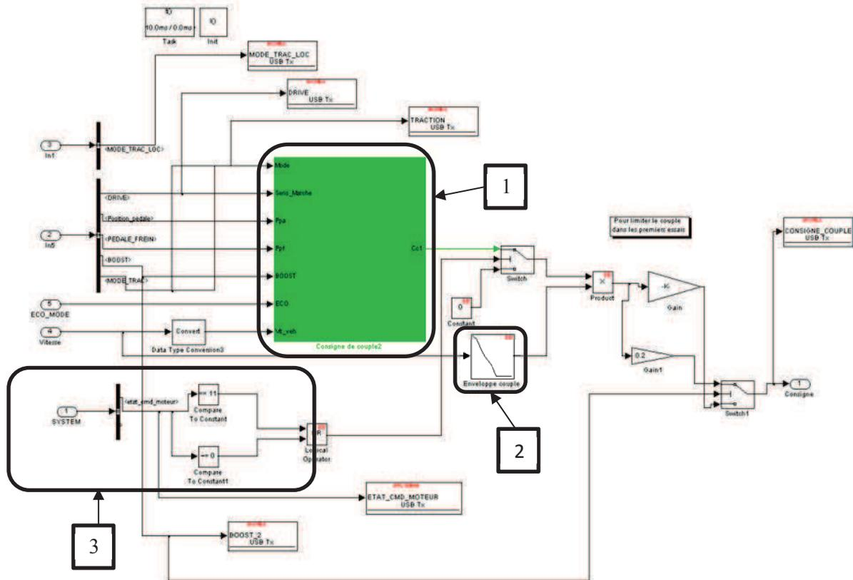
Figure 4.29 : Schéma Simulink de la consigne de couple.
