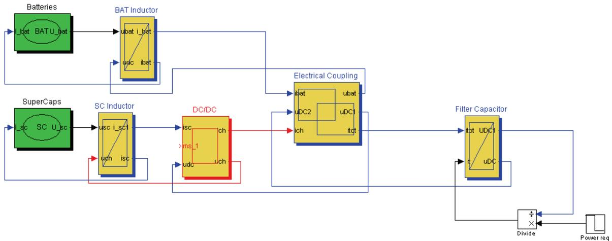
Figure 3.20 : Schéma Simulink du modèle REM du couplage des batteries et des supercondensateurs
