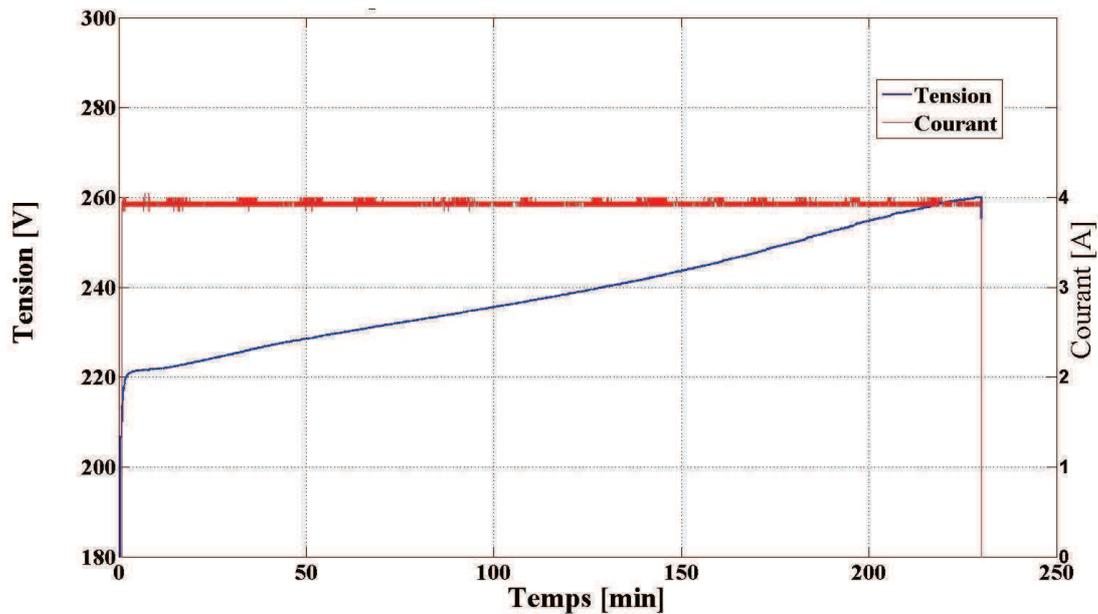
Figure 5.10 : Tension et courant des batteries durant la charge à courant constant.
