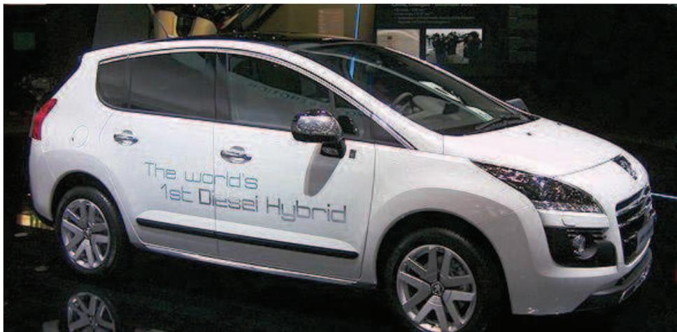
**Figure 1.9 :** Véhicule hybride Peugeot 3008.
