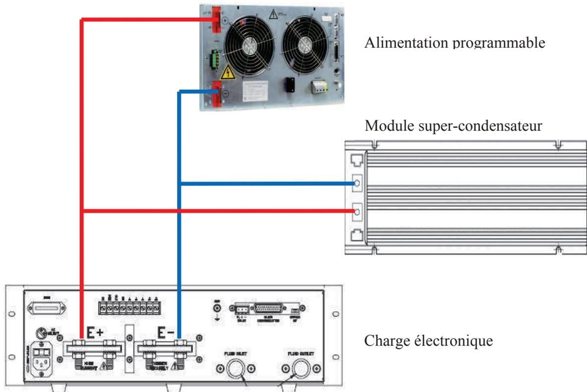
**Figure 2.15** : Schéma de câblage de puissance des supercondensateurs.
