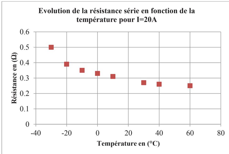
Figure 2.33 : Résistance en fonction de la température.
