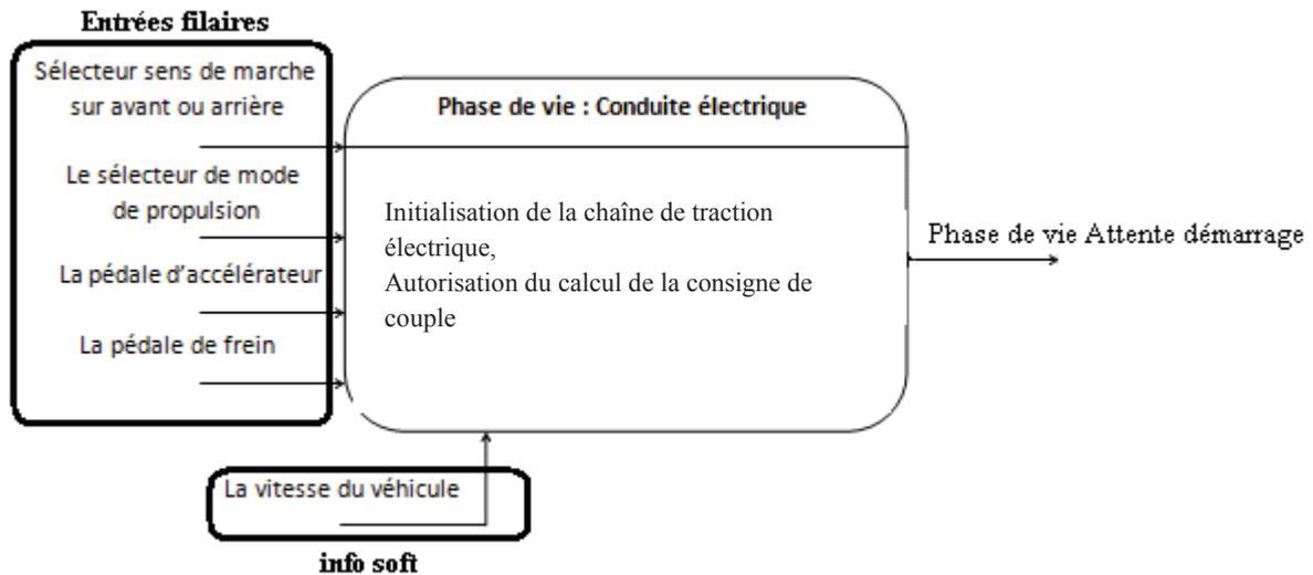
**Figure 4.6 :** *Modèle phase de vie "Conduite électrique".*
