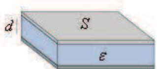
Figure 2.5 : Condensateur plan.
