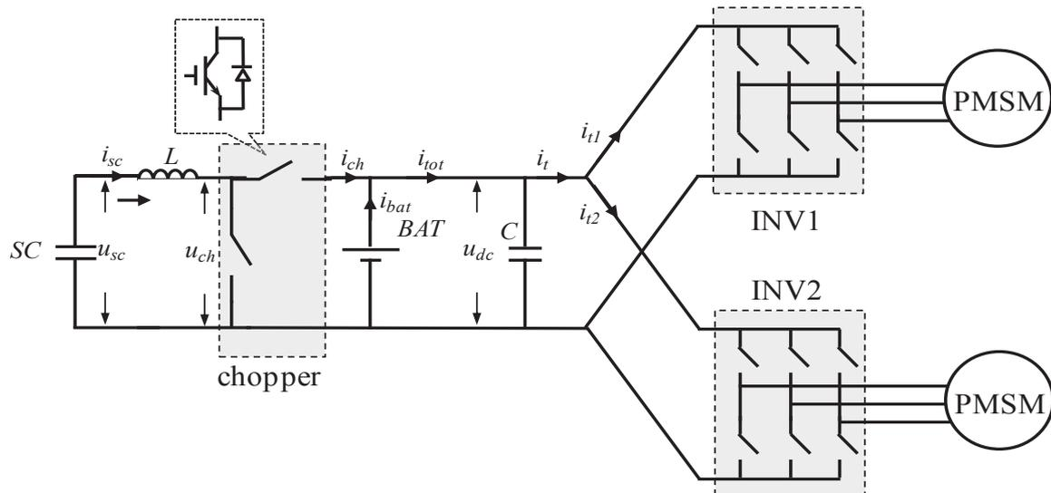
Figure 3.8 : Système de traction électrique de PHEBUS.
