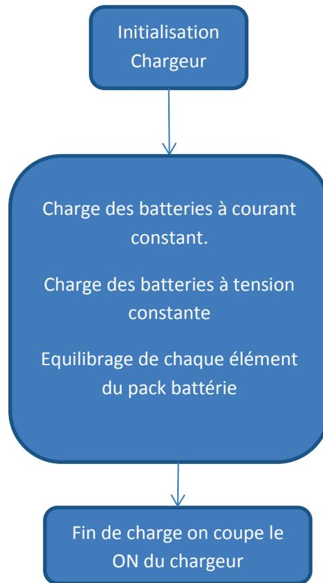
**Figure 4.22 :** *Algorithme de charge des batteries.*
