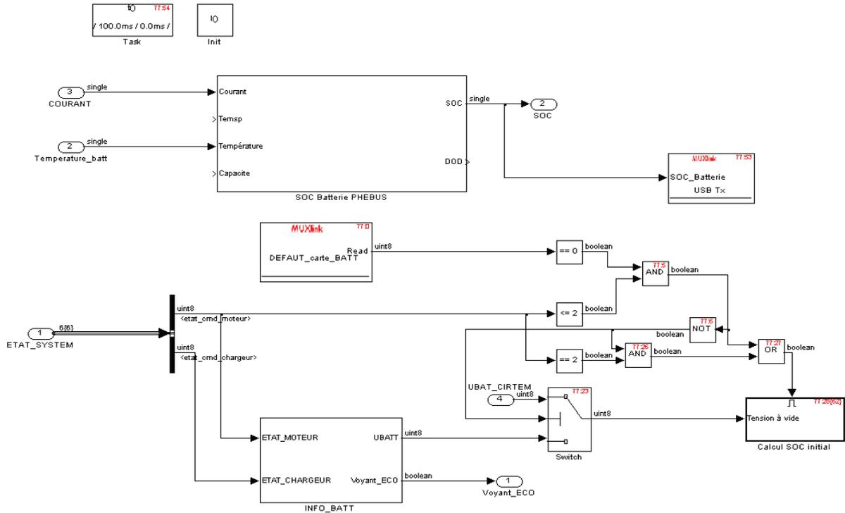
Figure 4.18 : Schéma Simulink de gestion de la batterie.
