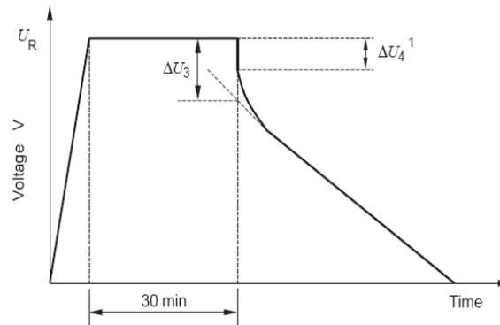
**Figure 2.19 :** Charge et décharge des supercondensateurs à courant constant.
