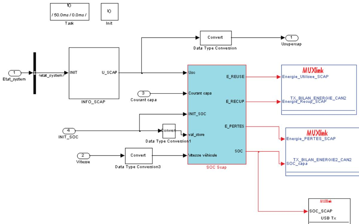
Figure 4.26: Schéma Simulink de gestion des supercondensateurs.
