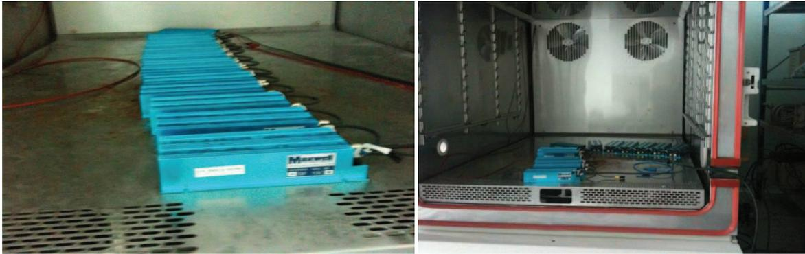
**Figure 2.32 :** Photographie des supercondensateurs dans la chambre climatique.
