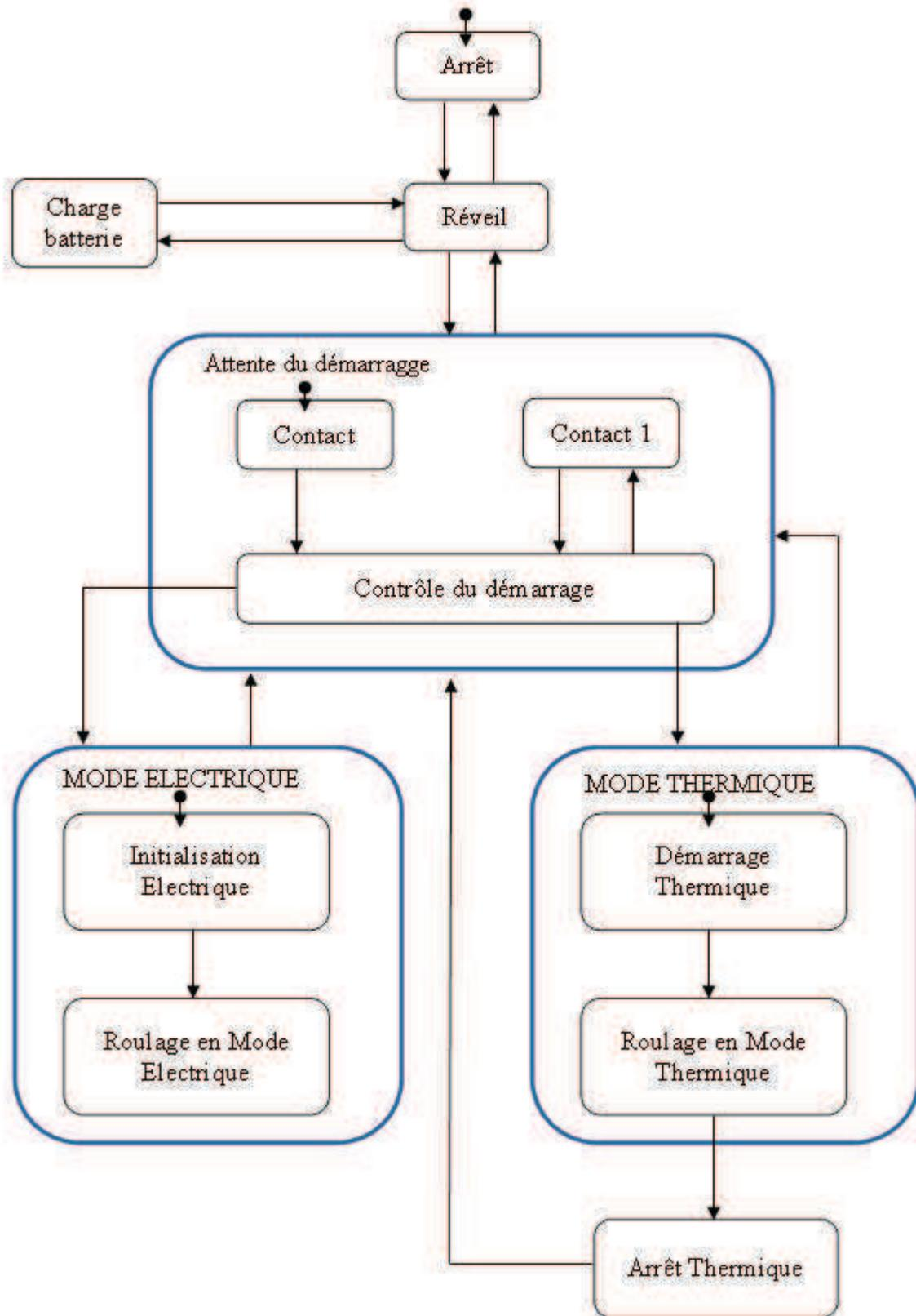
Figure 4.1 : Diagramme des phases de vie.
