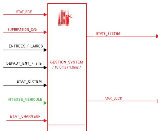
Figure 4.31 : Bloc Simulink de gestion du système (BGE).
