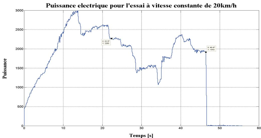
**Figure 5.20 :** *Puissance en fonction du temps.*
