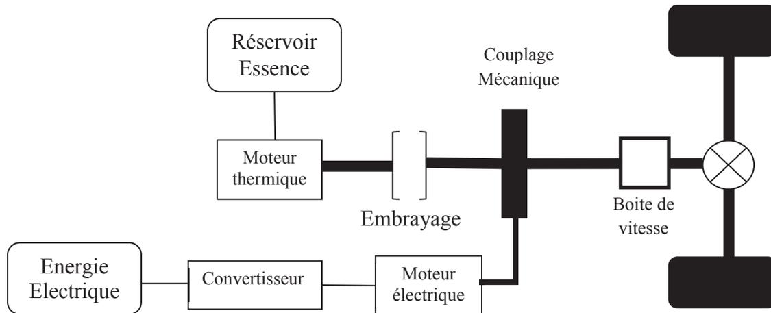
**Figure 1.6 :** Architecture parallèle d'un véhicule hybride.
