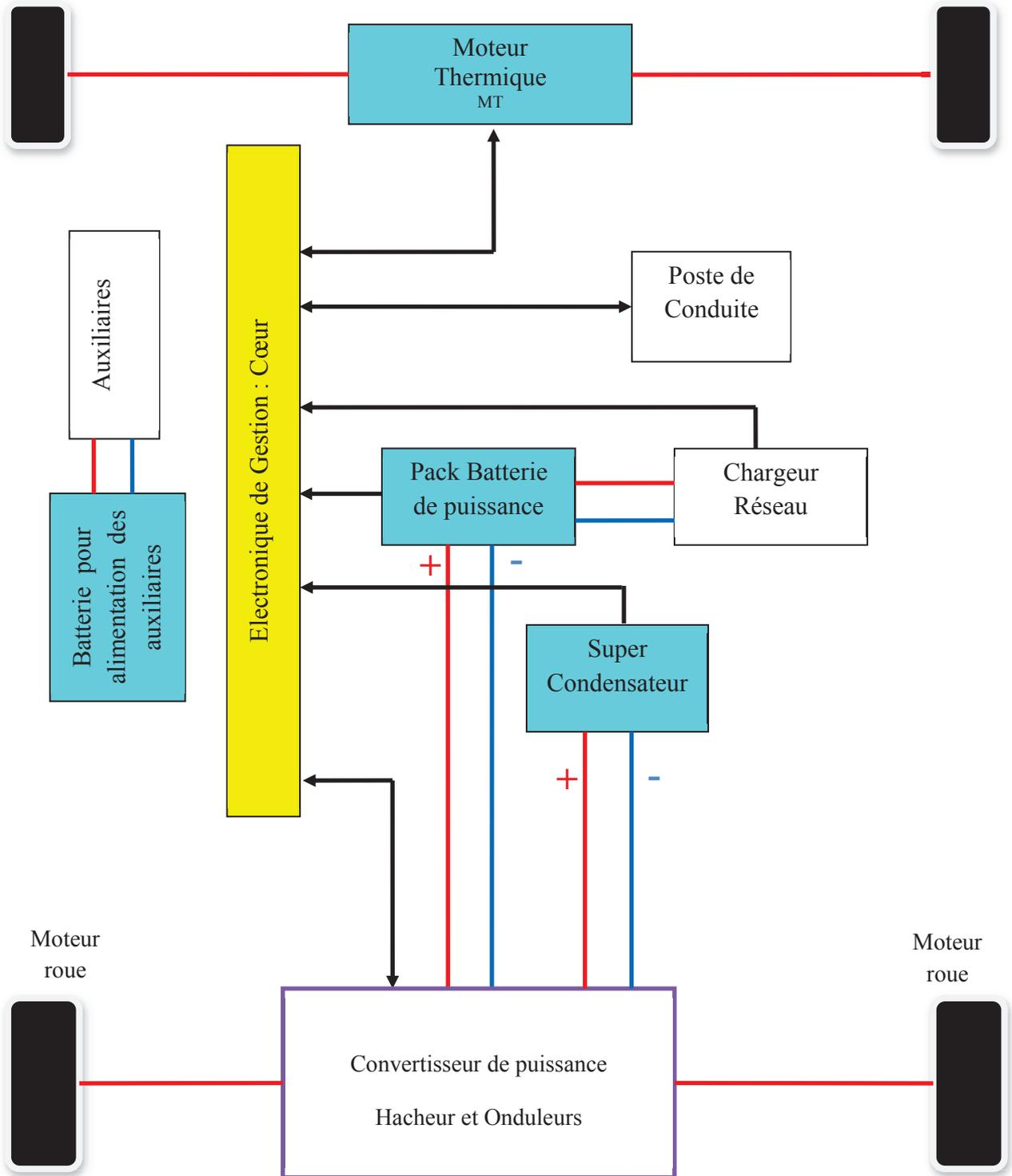
Figure 3.1 : Synoptique fonctionnel du véhicule PHEBUS.
