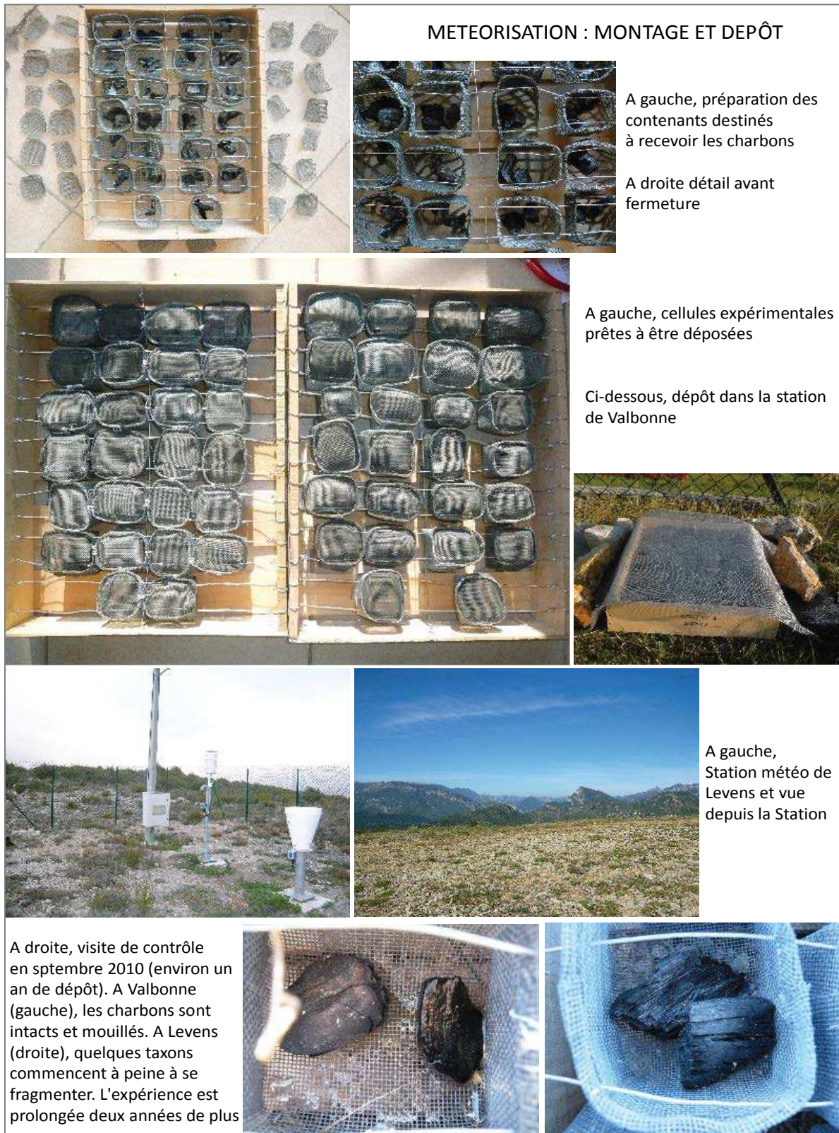
Planche 8 : Mise en place de l'essai de météorisation
