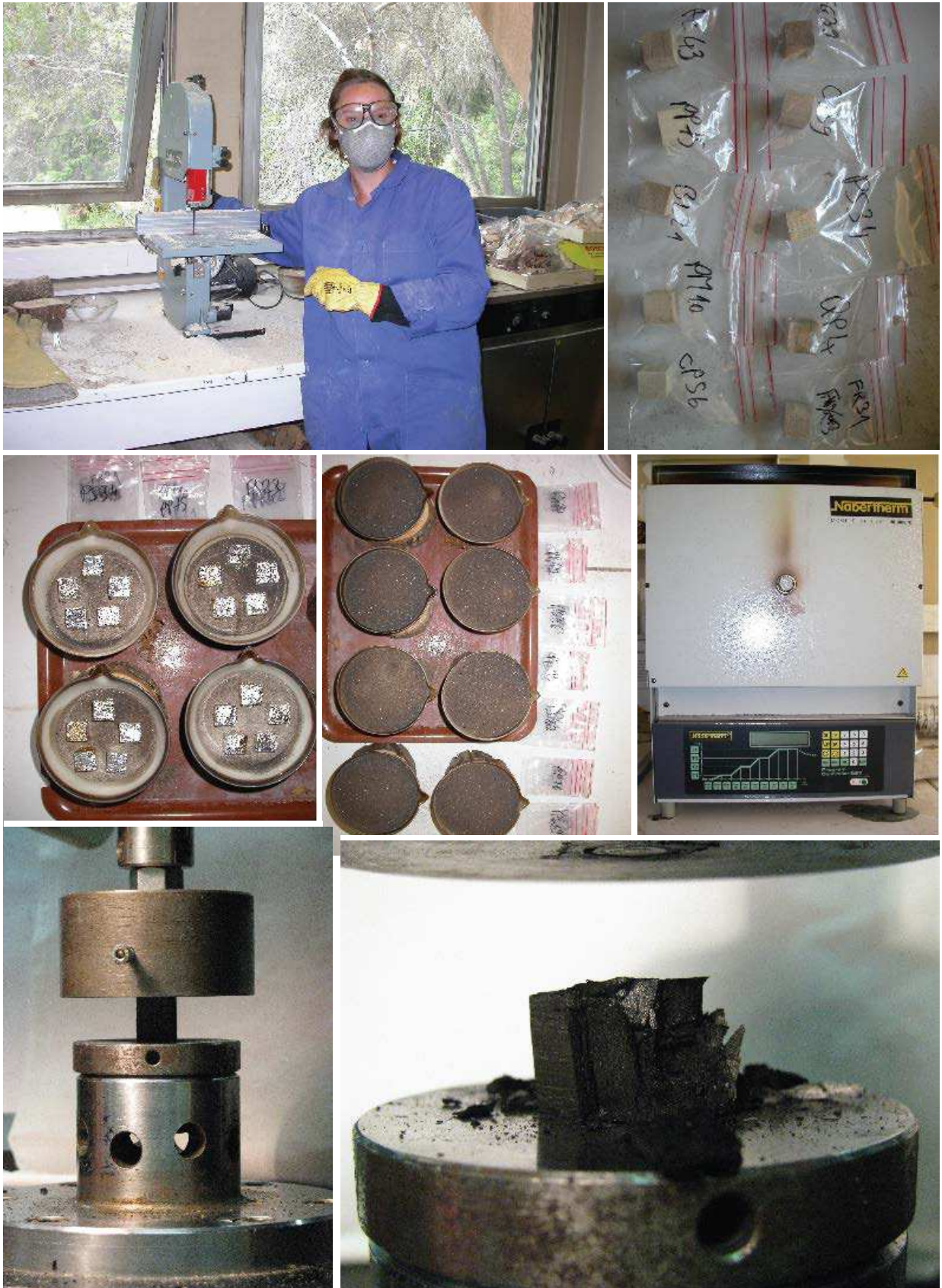
Planche 1' : Préparation des échantillons destinés à la caractérisation des propriétés mécaniques des charbons de bois et premiers tests de compression
