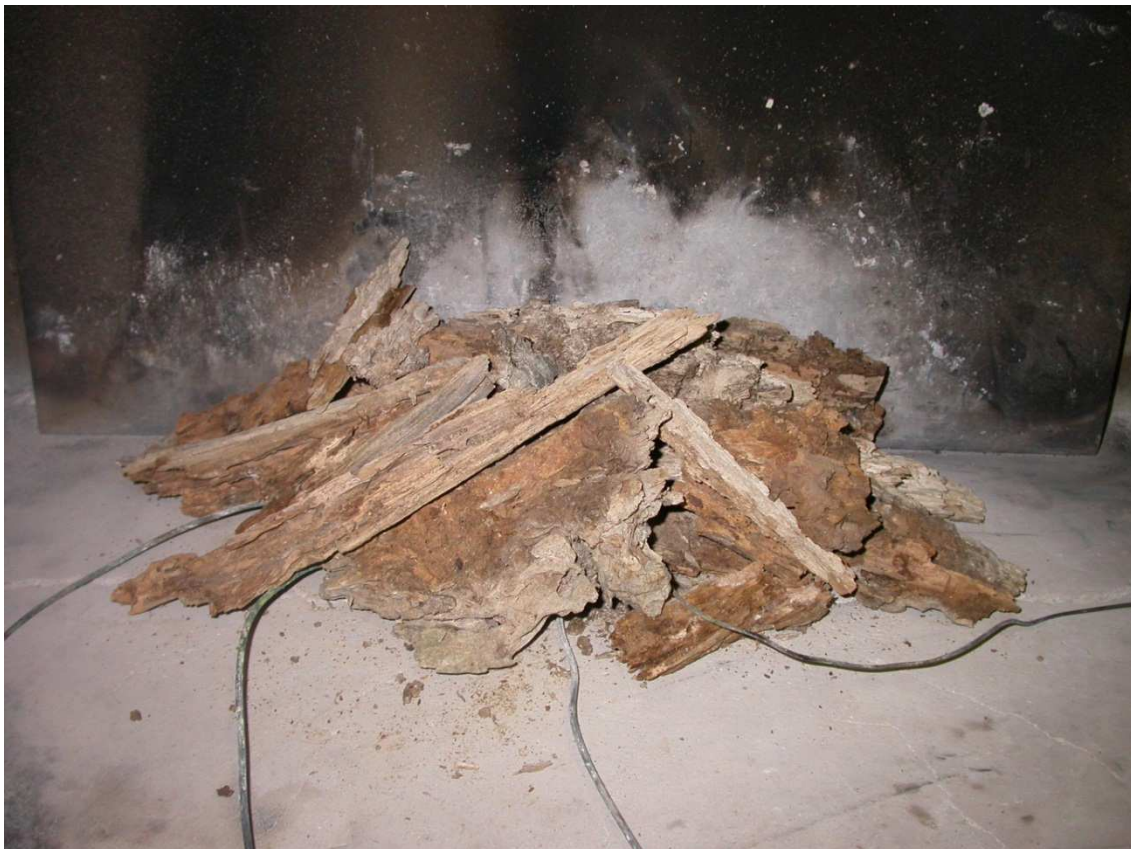
Figure 79 : Pinus sylvestris altéré avant combustion
