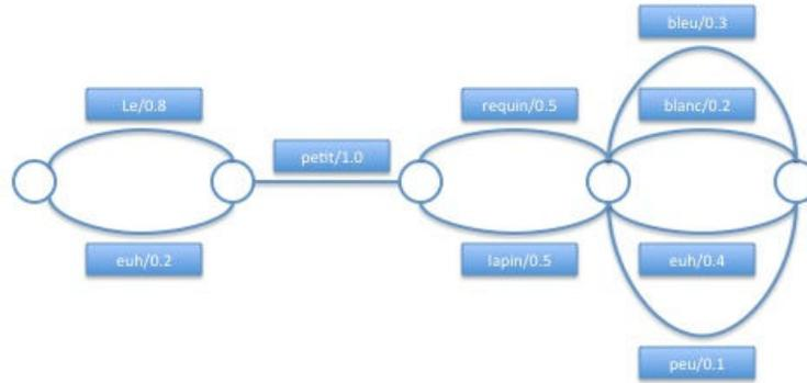
FIGURE 2.2 – Exemple d'un treillis de mot.
