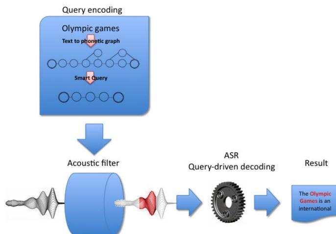
FIGURE 3.2 – Architecture d’un système de détection de terme à la volée.
