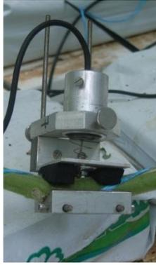
**Figure 22:** Capteur mesurant les variations ( $\mu\text{m}$ ) du diamètre de tige des plantes, l'acquisition des données est réalisée automatiquement en continu (Huguet *et al.*, 1992).
