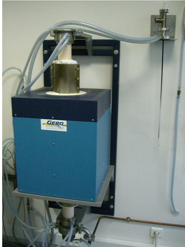
Figure 2-1 : Four vertical du laboratoire LGE de l'Université Paris-Est-Marne-la-Vallée ayant servi à la synthèse des verres modèles sous atmosphère réductrice ou oxydante.
