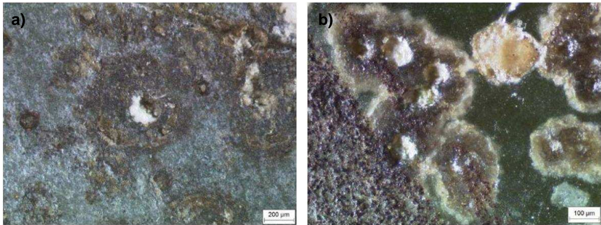
Figure 4-31 : Observation au microscope optique de taches brunes présentant un cratère en leurs centres et autour des cernes concentriques de différentes teintes. a) PEN1a : Face interne ; b) FDAT3 : Face interne.
