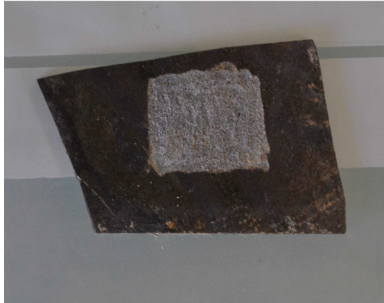
Figure 6-2 : Echantillon de vitrail historique LANN. Le carré gris d'environ 1 cm 2 est l'endroit où la surface du vitrail a été grattée à l'aide d'une fraise Dremel®.
