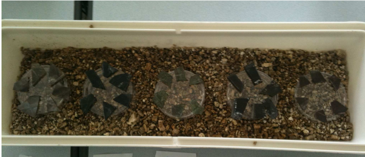
Figure 6-1 : Photographie de l'enceinte humide avec lit de vermiculite. Les échantillons sont posés sur des supports face externe vers le lit de vermiculite. Lors des 6 semaines de réactivation l'enceinte est fermée.
