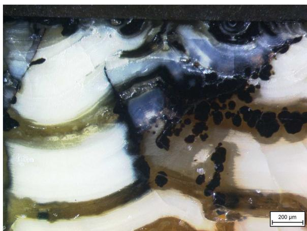
Figure 4-40 : Observation au microscope optique de la coupe de l'échantillon R1. Le faciès d'altération est très épais, il n'y a plus de verre sain.
