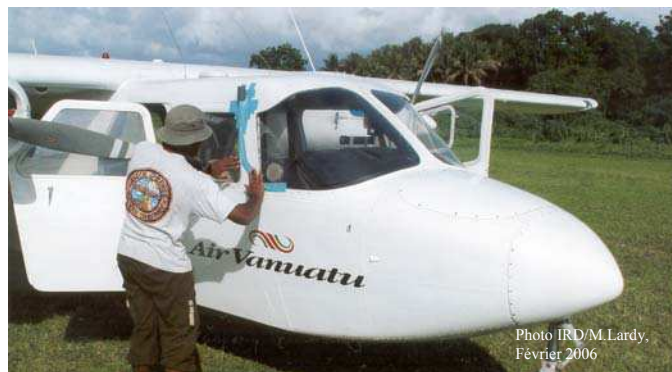
Figure 6-4. Installation d'un télescope sur un Brittan-Norman Islander d'Air Vanuatu. Ce dernier est relié à un spectromètre installé à l'intérieur de l'avion.
