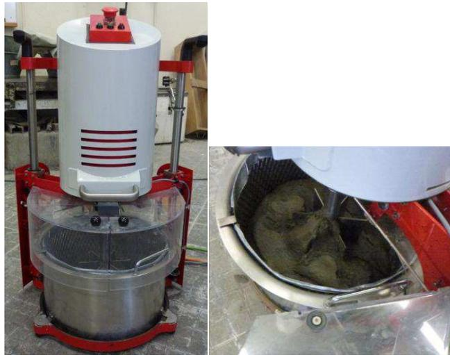
Figure 2.3 – BTRHEOM équipé de la géométrie Vane.
