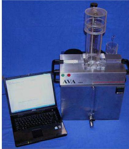
Figure 4.3 – Système AVA-3000 (photo de Germann Instruments) [33].
