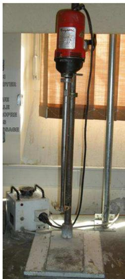
Figure 2.15 – Agitateur magnétique Turbo Test Rayneri Groupe VMI.
