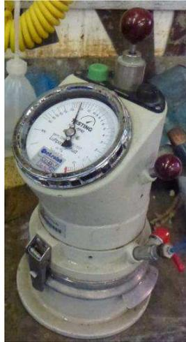
Figure 2.5 – Aéromètre à mortiers CONTROLAB.
