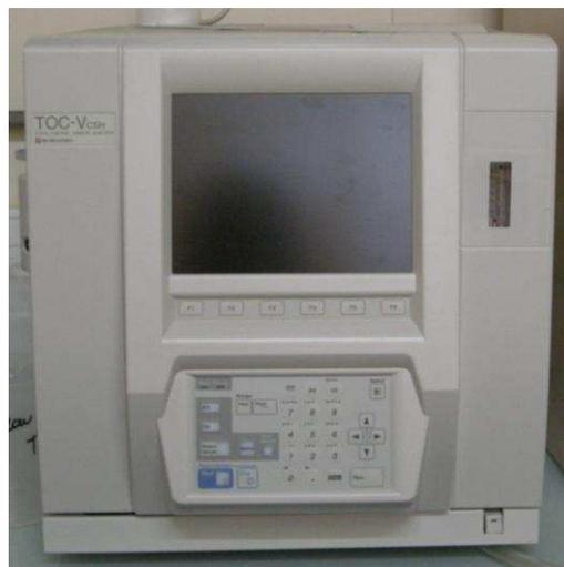
Figure 2.7 – Analyseur de carbone organique total TOC V<sub>CSH</sub> Shimadzu.
