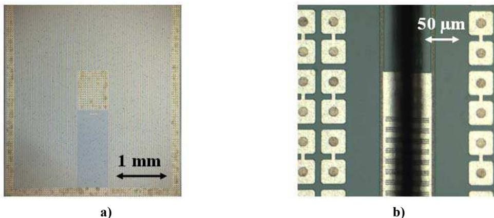
**Figure 2.16 : Observations microscopiques d'une puce découpée à 40000 rpm, 20 mm/s et 1,8 L/s**
