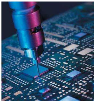
**Figure 1.23 : Photographie d'un dépôt de *CUF* par aiguille [Krayden 2013]**
