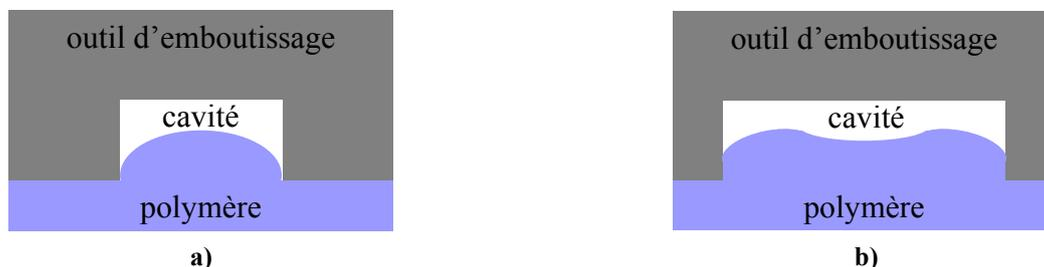
Figure 3.3 : Les deux modes de remplissage possible lors du procédé d'emboutissage [Rowland 2005]
