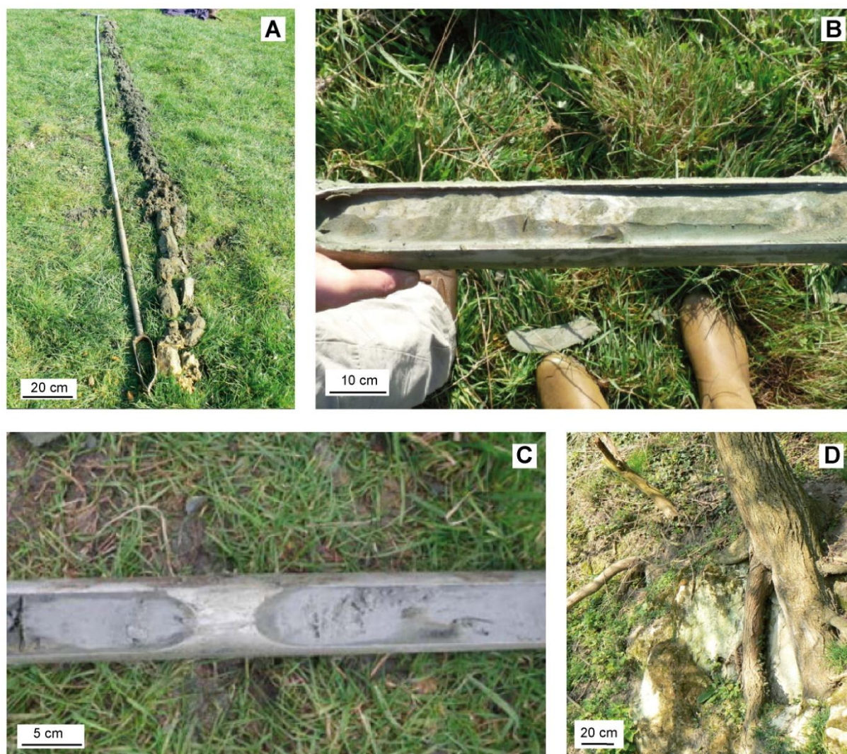
(A) Faciès de sables glauconieux en partie supérieure du sondage et craie altérée en partie inférieure (Lécaude, mars 2011) ; (B) faciès argilo-glauconieux (Bonneville-sur-Touques, octobre 2011) ; (C) faciès marneux (Grandchamp-le-Château, novembre 2012) et (D) affleurement de craie altérée sur la partie médiane de l'escarpement principal (Lécaude, mars 2011)
