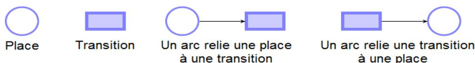
**Figure 2.2** Les éléments constituant un réseau de Petri
