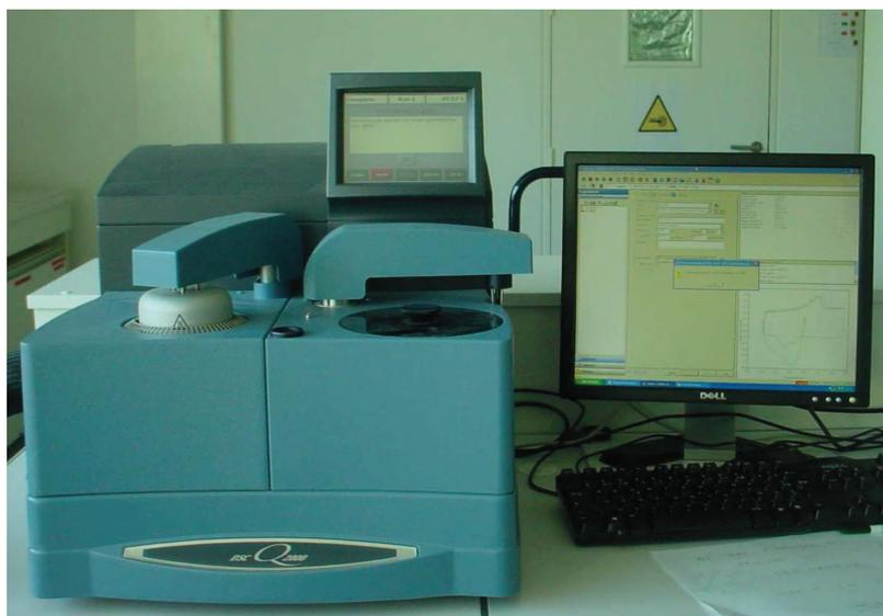
**Figure 9** : Appareil DSC Q2000
