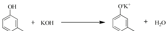
Figure III.21 : Réaction de KOH avec le m-crésol
