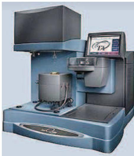
**Figure 11** : Appareil TGA Q500
