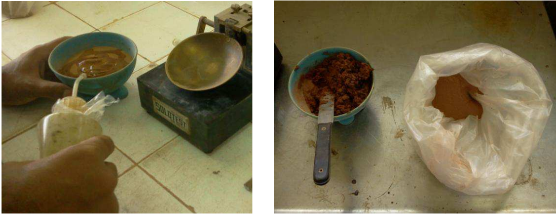
Figure 4.3. Prétraitement de l'échantillon pour déterminer les limites d'Atterberg (norme brésilienne)
