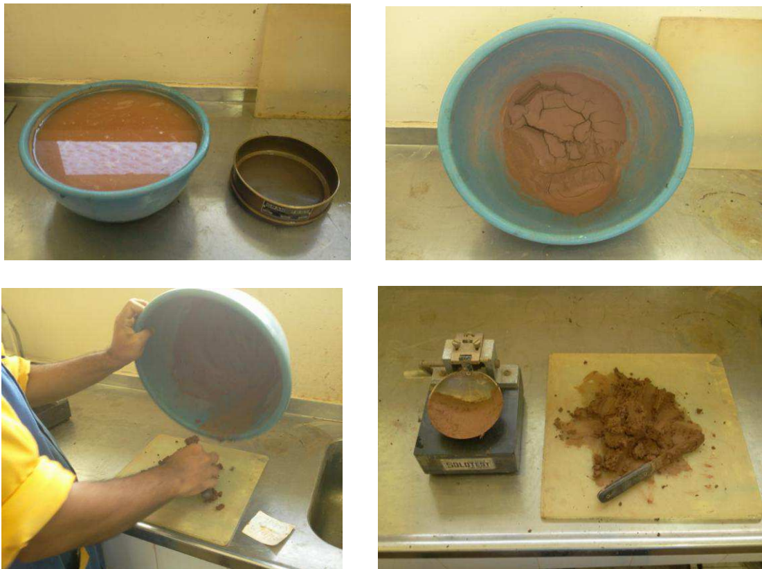
Figure 4.4. Prétraitement de l'échantillon pour déterminer les limites d'Atterberg (norme française)
