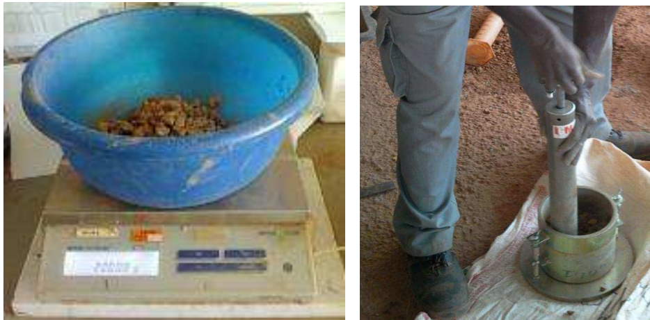
Figure 2.8. Étude de la durabilité de la fraction 10/20 mm de la latérite de Lam-Lam : essai de fragmentabilité
