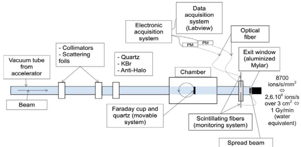
Figure 34 : Schéma complet de la ligne d'irradiation Radiograaff.
