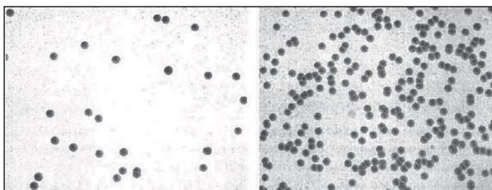
Figure 26 – Impacts d'ions argon 95 MeV/u sur des plaques CR39 à différentes fluences.  $3,5 \cdot 10^4$  ions/cm<sup>2</sup> (gauche) et  $3,5 \cdot 10^5$  ions/cm<sup>2</sup> (droite). Le rayon d'une trace est d'environ 4  $\mu\text{m}$ .
