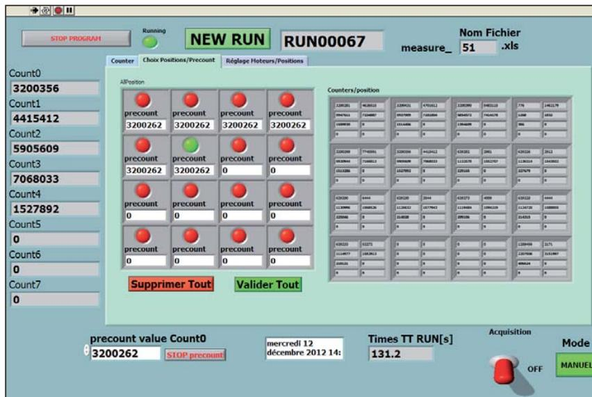
Figure 22 – Exemple d'un onglet du programme d'acquisition Labview. « Choix positions/Precount » consiste en la définition du précompte pour chaque échantillon à irradier.
