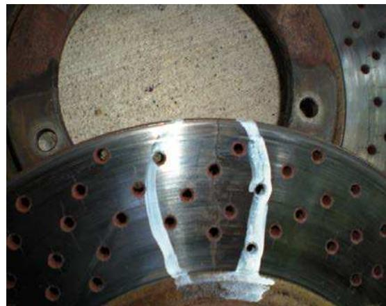
**Figure 2.6 : Fissures sur un disque de frein**
