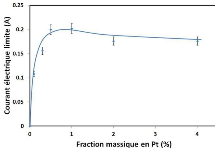
**Figure 5.6 : Courant limite en fonction de la teneur massique visée de Pt par photodépôt, 1 g.L<sup>-1</sup> de photocatalyseur, flux d'azote à 20 ml.min<sup>-1</sup>, PEMFC avec Pt en catalyseur à l'anode, système photocatalytique A, déshydrogénation du méthanol**
