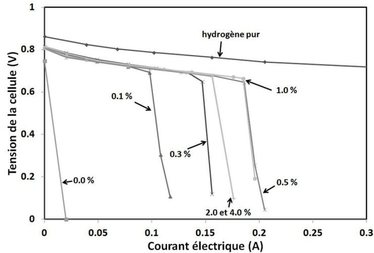
**Figure 5.5 : Courbes de polarisation en fonction de la teneur massique visée de Pt par photodépôt, 1 g.L<sup>-1</sup> de photocatalyseur, flux d'azote à 20 ml.min<sup>-1</sup>, PEMFC avec Pt en catalyseur à l'anode, système photocatalytique A, déshydrogénation du méthanol**
