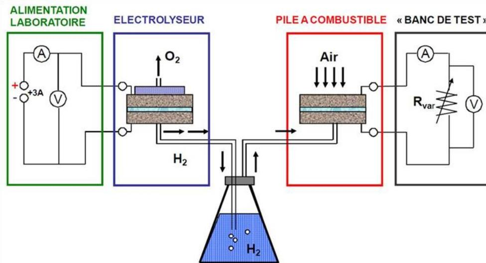
**Figure 2.11 : Représentation schématique du couplage électrolyseur/PEMFC, par PaxiTech**
