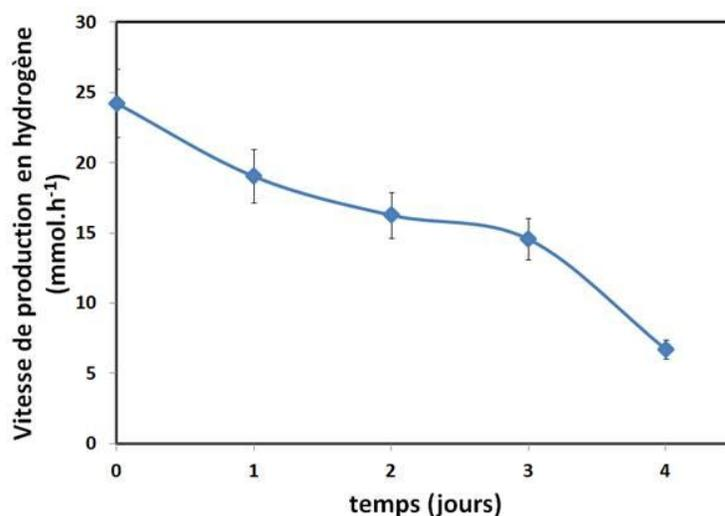
**Figure 5.15 : Vitesse de production en hydrogène identifiée via la PEMFC (Pt à l'anode) sous flux d'azote au cours du temps, à 220 mV maintenu, déshydrogénation du méthanol, système photocatalytique B**
