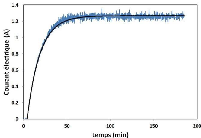
**Figure 5.4 : Obtention d'un courant limite à 220 mV sous flux d'azote pour une concentration en photocatalyseur de 1,0 g.L<sup>-1</sup>, PEMFC avec Pt à l'anode, système photocatalytique B, déshydrogénation du méthanol**
