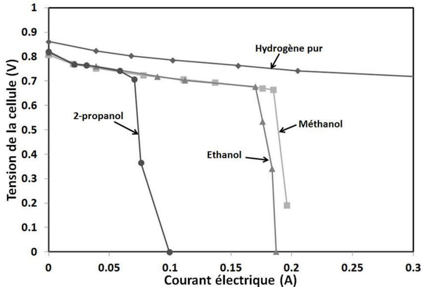
**Figure 5.7 : Courbes de polarisation obtenues pour le méthanol, l'éthanol et le 2-propanol, 1 g.L<sup>-1</sup> de photocatalyseur, flux d'azote à 20 ml.min<sup>-1</sup>, PEMFC avec Pt en catalyseur à l'anode, système photocatalytique A, réactions de déshydrogénation d'alcools**
