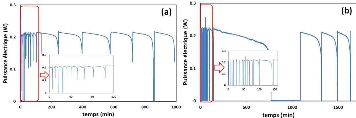
**Figure 5.12 : Maintien de 0,3 A par réalisation de purges régulières pour la déshydrogénation du méthanol (a) et le reformage du méthanol à 50 vol.%, PEMFC avec Pt à l'anode sous 1,1 bar, système photocatalytique B**
