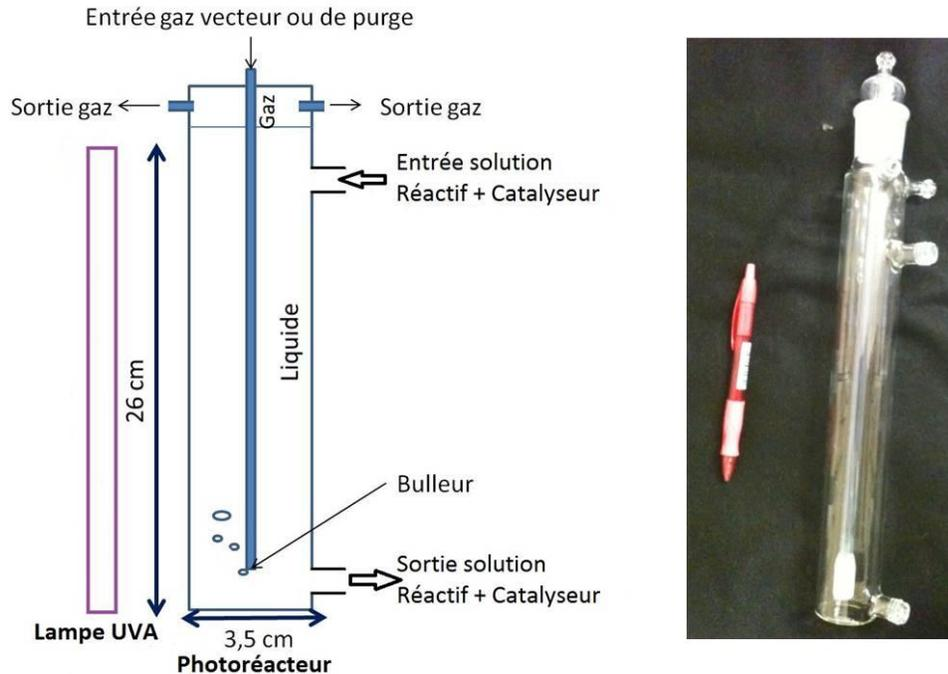
**Figure 5.1 : Dimension d'un photoréacteur pour le couplage**
