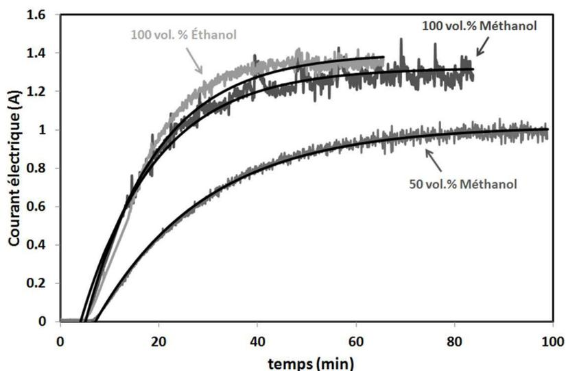
**Figure 5.10 : Courant limite obtenu à 220 mV sous flux d'azote pour différentes réactions photocatalytiques, 1 g.L<sup>-1</sup> en Pt/TiO<sub>2</sub> à 1,0 pds. % en Pt, PEMFC avec Pt à l'anode, système photocatalytique B**
