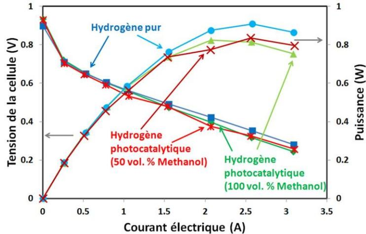
**Figure 5.17 : Comparaison entre les performances obtenues sous hydrogène pur et photocatalytique en déshydrogénation et reformage du méthanol pour la PEMFC avec catalyseur de Pt-Ru à l'anode, 1,1 bar**
