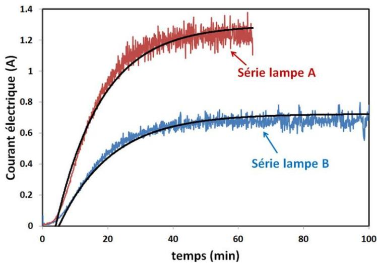
**Figure 5.9 : Courants limites obtenus à 220 mV pour deux flux de photons, déshydrogénation du méthanol, 1 g.L<sup>-1</sup> en Pt/TiO<sub>2</sub> à 1,0 pds. % Pt, PEMFC avec Pt à l'anode, système photocatalytique B**
