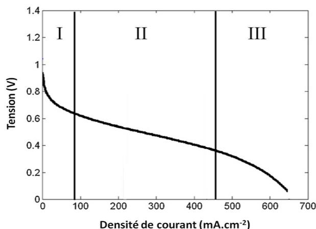
**Figure 1.6 : Courbe de polarisation classique d'une pile à combustible<sup>48</sup>**
