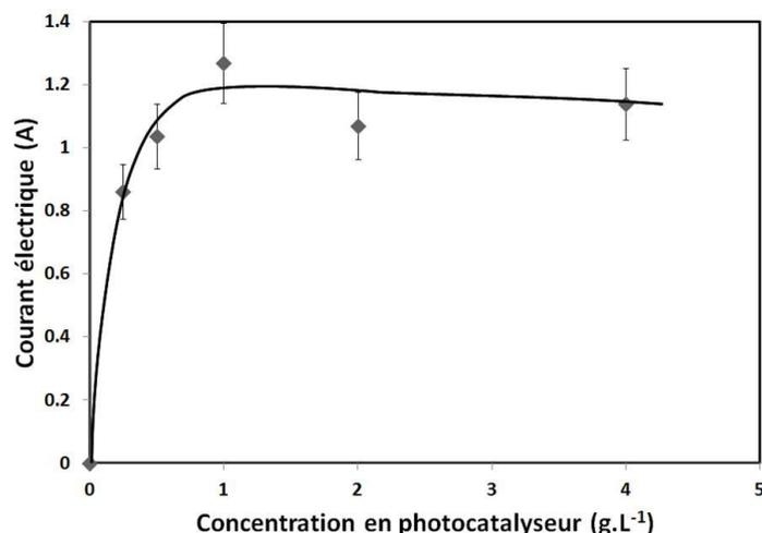
**Figure 5.8 : Courant limite obtenu à 220 mV en fonction de la concentration en Pt/TiO<sub>2</sub> (1,0 pds. % en Pt) via la déshydrogénation photocatalytique du méthanol, PEMFC avec Pt à l'anode, système photocatalytique B**
