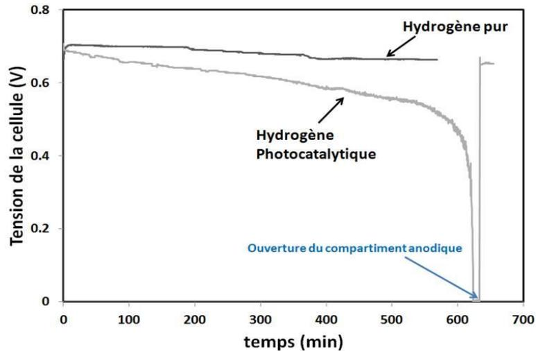
**Figure 5.11 : Comparaison d'un fonctionnement *dead-end mode* via de l'hydrogène pur et photocatalytique via le reformage du méthanol (50 vol.%) à 0,3 A maintenu sous 1,1 bar, PEMFC avec Pt à l'anode, système photocatalytique B**
