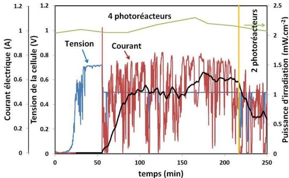
**Figure 5.26 : Tension et courant électrique de la PEMFC avec Pt-Ru à l'anode, ainsi que puissance d'irradiation solaire au cours du temps (jour 2), avec un système photocatalytique de 4, puis 2 photoréacteurs, déshydrogénation du méthanol (1,0 L), 1,0 bar**
