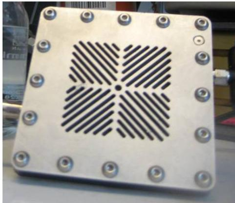
Figure 2.10 : PEMFC, PaxiTech, 25 cm<sup>2</sup>, point de vue du compartiment cathodique
