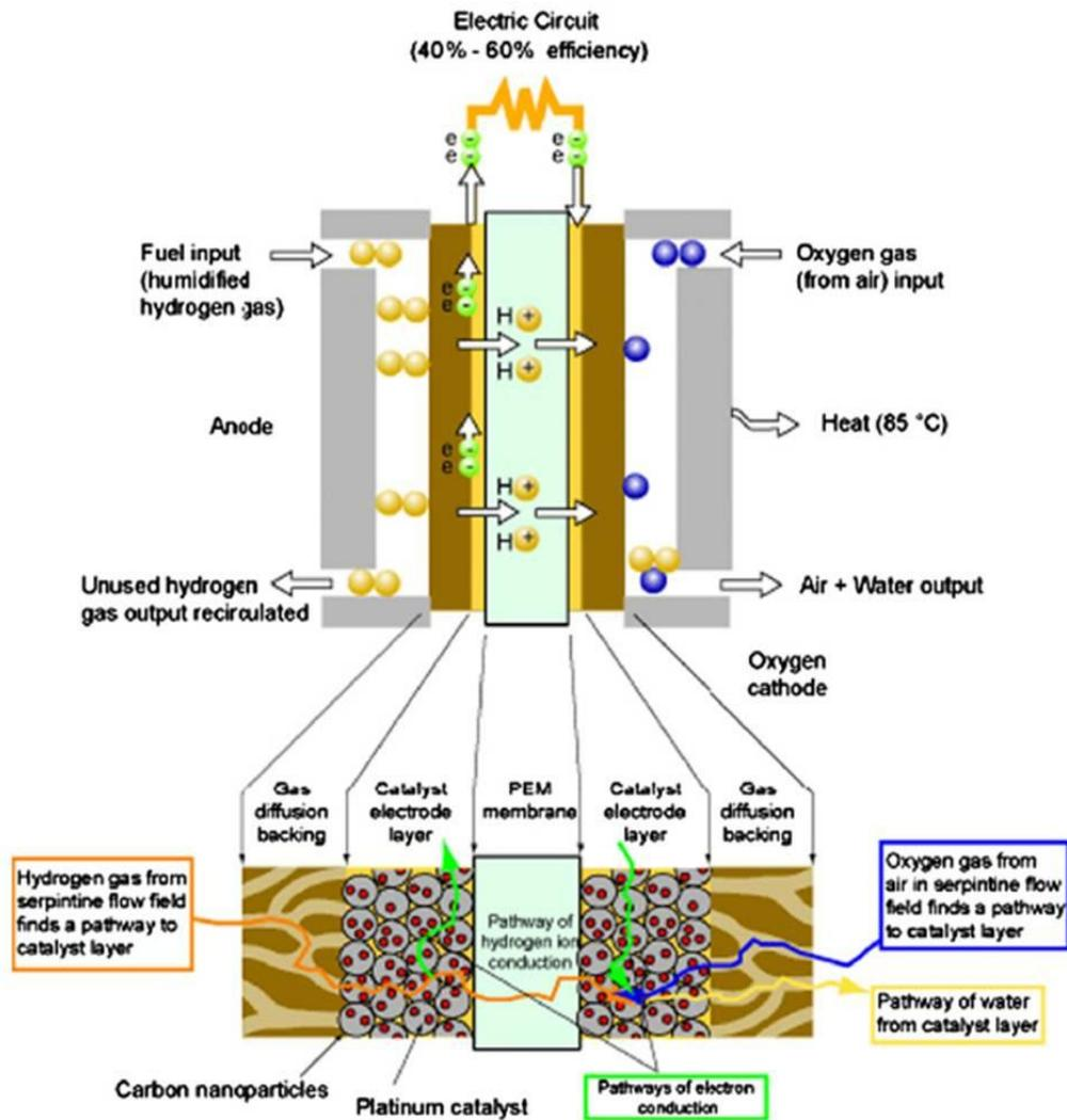
Figure 1.4 : Principe de fonctionnement d'une PEMFC<sup>30</sup>
