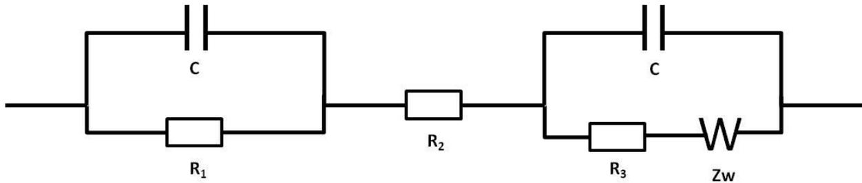
Figure 2.13 : Circuit équivalent<sup>46</sup>
