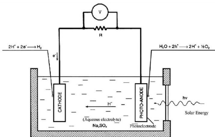
Figure 1.9 : Schéma d'une cellule photo-électrochimique<sup>96</sup> (adapté de Fujishima et Honda<sup>108</sup>)
