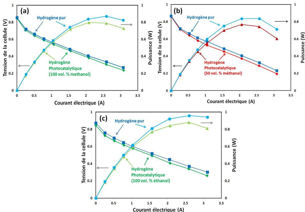
**Figure 5.16 : Comparaison entre les performances obtenues sous hydrogène pur et photocatalytique en déshydrogénation (a) et reformage (b) du méthanol et en déshydrogénation de l'éthanol (c) pour la PEMFC avec catalyseur de Pt à l'anode, 1,1 bar**
