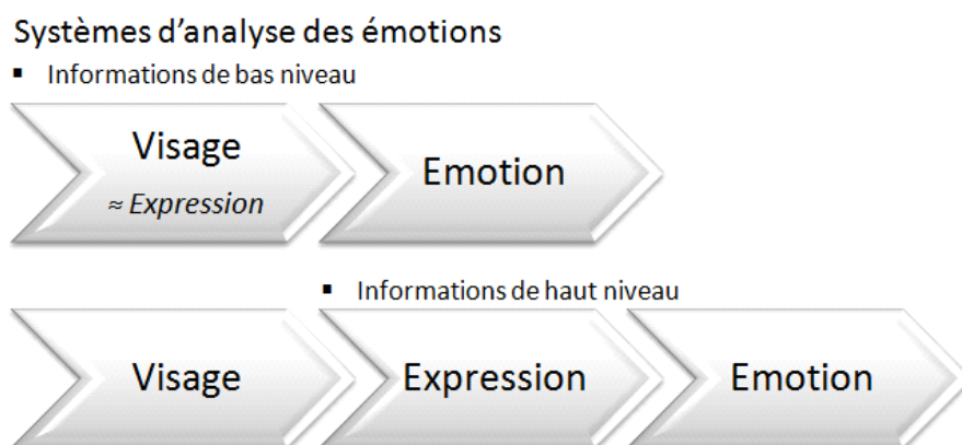
FIGURE 2.4 – Étapes des systèmes d'analyse des émotions. Deux méthodes : dans la première, l'analyse des émotions se fait à partir des informations des visages (informations de bas niveau) ; dans la seconde, l'analyse des émotions se fait à partir des informations des expressions (informations de haut niveau).
