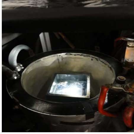
FIGURE 2.3 – Photographie du montage. On observe la cellule grise au centre du solénoïde, qui est éclairé. La surface métallique réfléchissante est particulièrement visible. Les câbles rouges d'alimentation de la bobine sont à droite et la circulation d'eau pour le refroidissement de la bobine à gauche.
