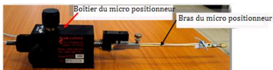
Figure III.22 : Micro positionneur de précision S725.
