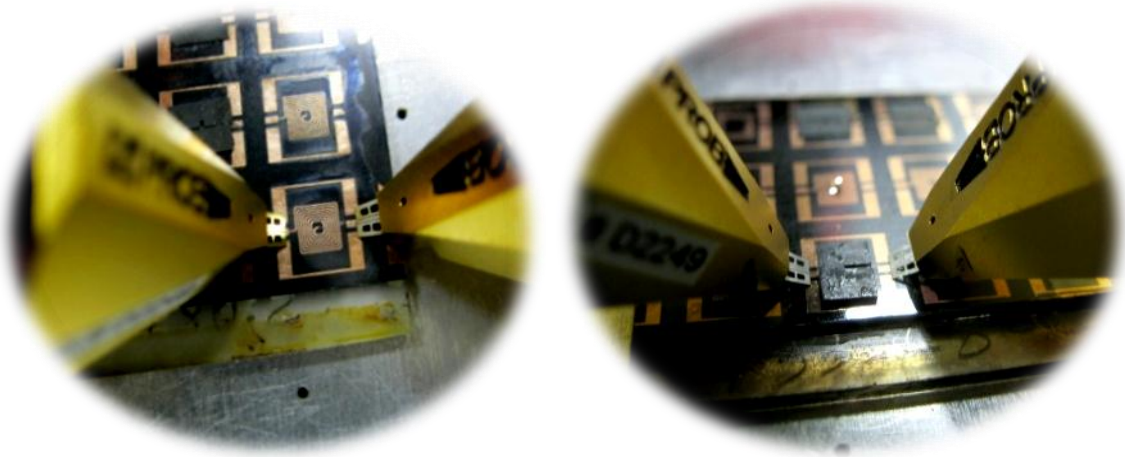
Figure IV.14: Inductances à une et deux couches de YIG sous le testeur.
