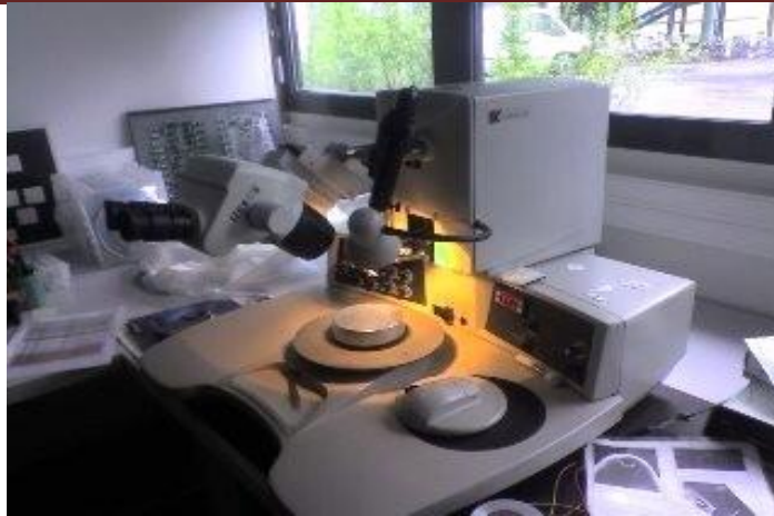
Figure III.8 : Machine KS4523 pour réaliser le bonding
