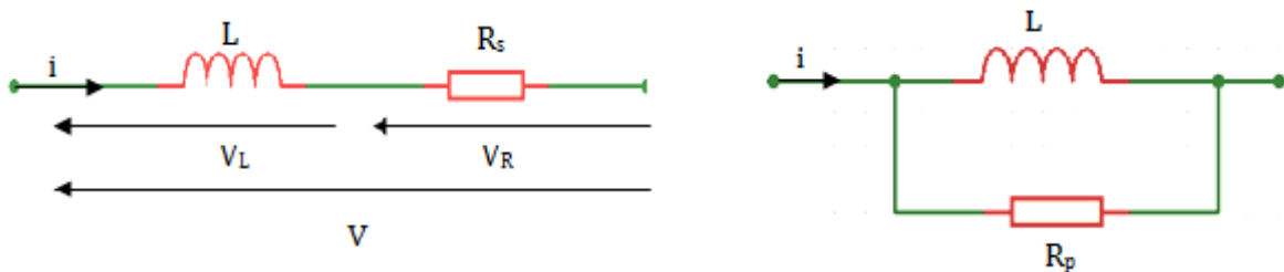
Figure II.10 : Modèle simplifié d'une inductance.
