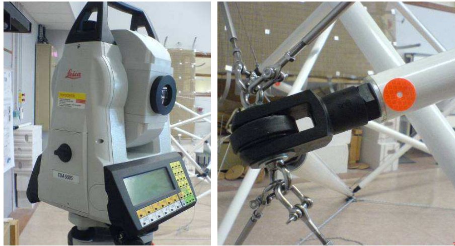
Figure 65. Mesure de la position des barres par l'intermédiaire du tachéomètre et de cibles réfléchissantes
