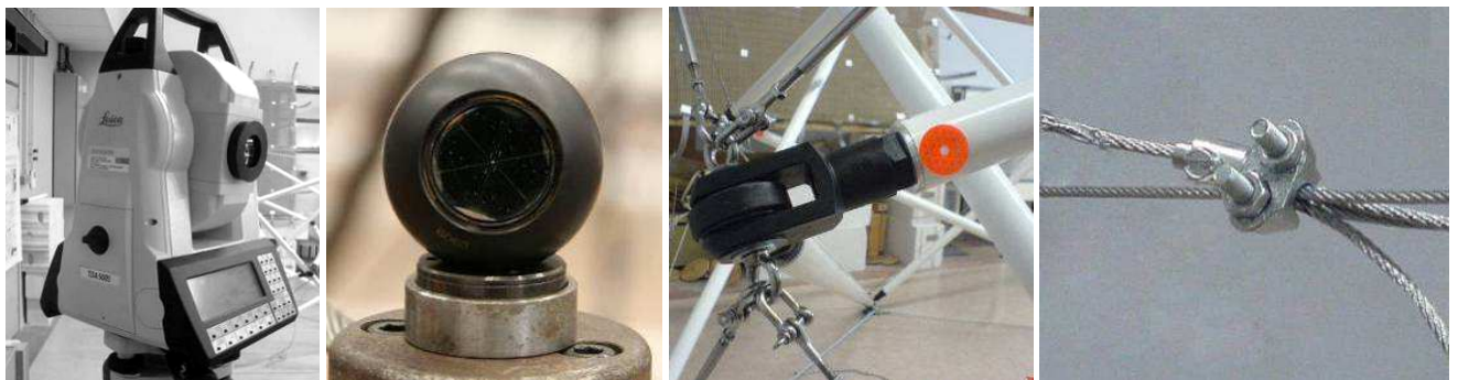
Figure 81. Dispositifs de mesure de la géométrie et de réglage du câble servant au pliage
