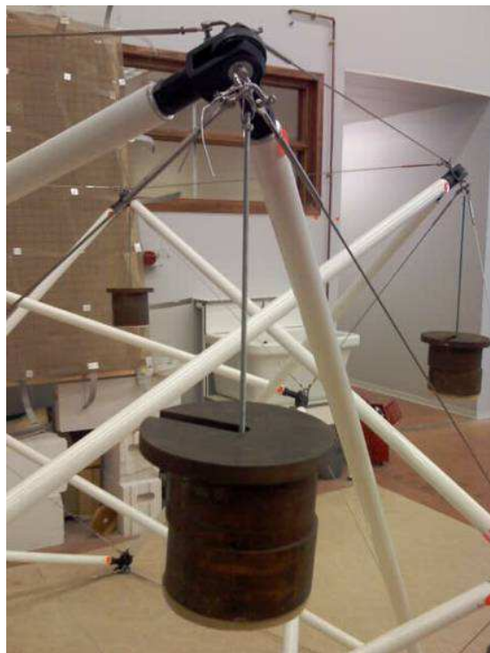
Figure 64. Chargement appliqué sur un nœud de l'anneau
